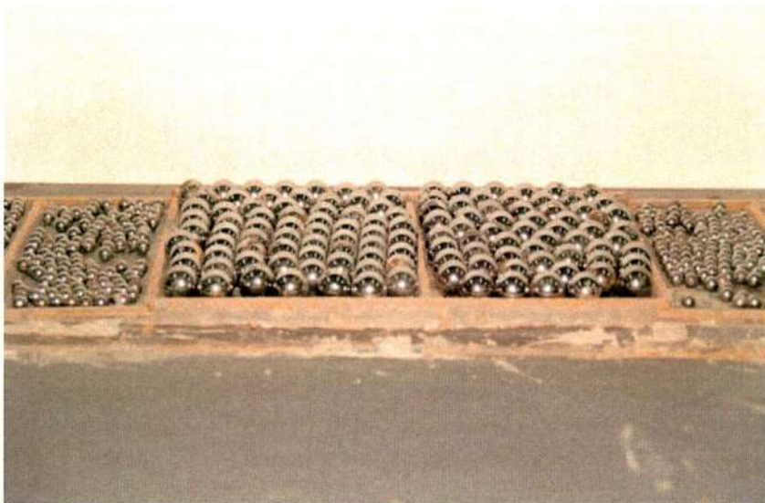
Φωτογραφία 3.9 : Βάση κύλισης δοκιμών με μεταλλικά σφαιρίδια για την μείωση των τριβών
