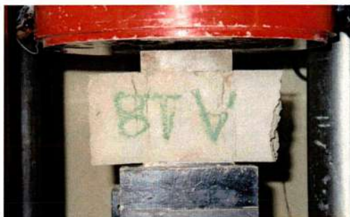
Φωτογραφία 3.2 : Δοκιμή ισοδύναμου κύβου
