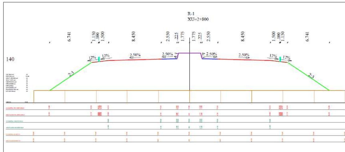
Σχήμα 6.7: Τυπική διατομή (επιφανειακά στοιχεία) σε ευθυγραμμία της εφαρμογής Π.1.
