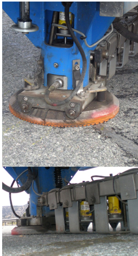
Φωτογραφία 7.4. Επιτόπου δοκιμές με το Σύστημα FWD
