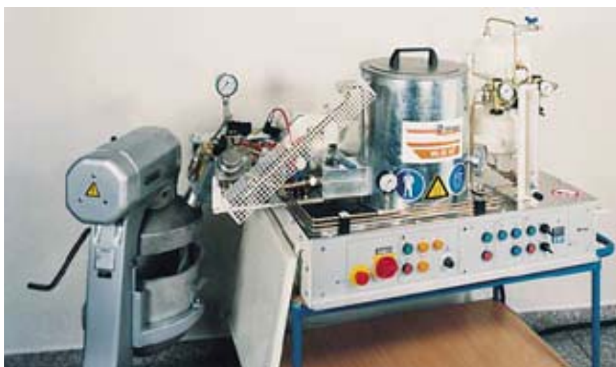
Φωτογραφία 2.2. Συσκευή για παραγωγή αφρώδους ασφάλτου στο εργαστήριο
