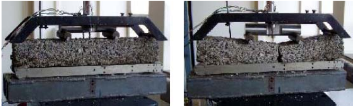
Φωτογραφία 2.7. Δοκιμή «ανηγμένης παραμόρφωσης κατά τη θραύση» (strain-at-break): δοκίμιο πριν και μετά τη θραύση (Long & Ventura 2004)
