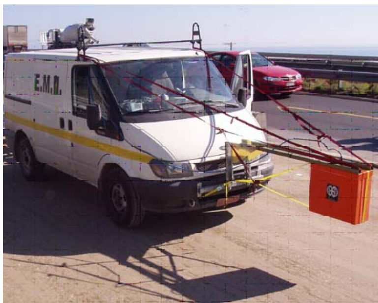
Σχήμα 4.3. Μέτρηση με το Σύστημα GPR στην επιφάνεια της κατεργασμένης στρώσης
