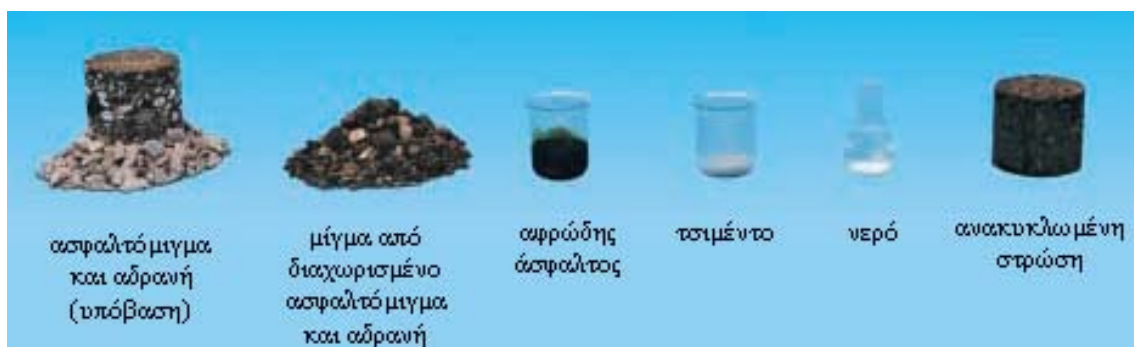
Φωτογραφία 2.3. Υλικά για παραγωγή μίγματος κατεργασμένου με αφρώδη άσφαλο
