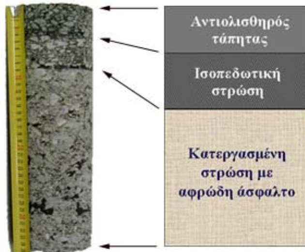
Σχήμα 4.7. Πυρήνας ανακυκλωμένου οδοστρώματος
