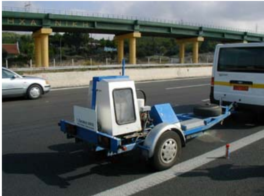
Φωτογραφία 4.1. Το σύστημα FWD του Εργαστηρίου Οδοποιίας του ΕΜΠ
