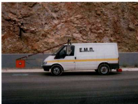
Εικόνα 8.1: Μέτρηση με το σύστημα GPR του Εργαστηρίου Οδοποιίας του ΕΜΠ στην Αττική Οδό
