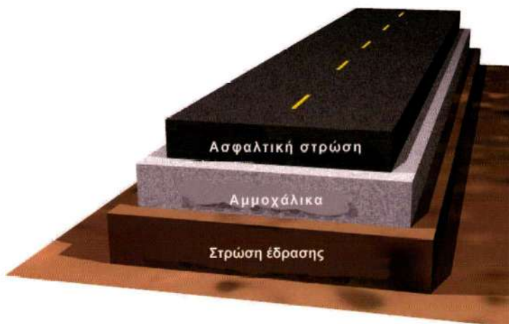
Σχήμα 7.3: Το οδόστρωμα θεωρούμενο ως σύστημα τριών στρώσεων
