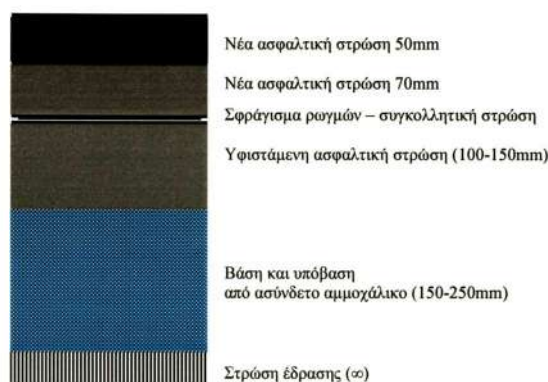
Σχήμα 6.7: Στατικό προσομοίωμα του οδοστρώματος του διαδρόμου του ΚΑΡΔ.
