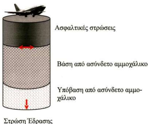
Σχήμα 6.3: Ενδεικτικό προσομοίωμα στρώσεων και κρίσιμων θέσεων ελέγχου αστοχίας ασφαλικού οδοστρώματος αεροδρομίου με βάση από αμμοχάλικο (εύκαμπτο).
