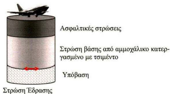
Σχήμα 6.4: Ενδεικτικό προσομοίωμα ημιακάμπτου οδοστρώματος αεροδρομίου.
