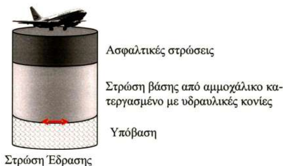
Σχήμα 2.3: Ενδεικτικό προσομοίωμα ημιακάμπτου οδοστρώματος αεροδρομίου.
