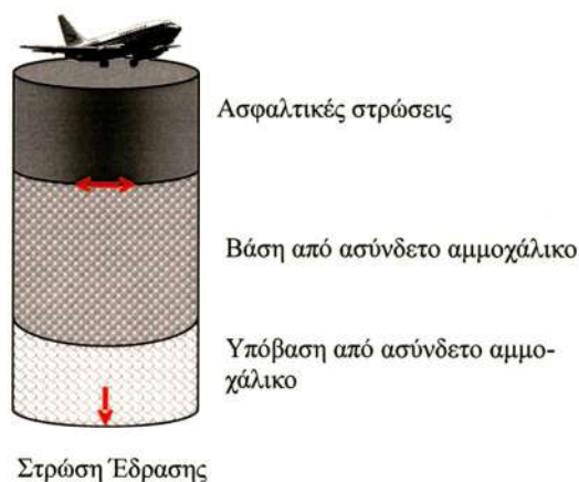
Σχήμα 3.1: Ενδεικτικό προσομοίωμα στρώσεων και κρίσιμων θέσεων ελέγχου αστοχίας ασφαλτικού οδοστρώματος αεροδρομίου με βάση από αμμοχάλικο (εύκαμπτο).
