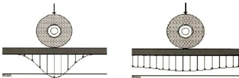
Σχήμα 2.2: Ποιοτική κατανομή τάσεων κάτω από εύκαμπτη και δύσκαμπτη στρώση [17].
