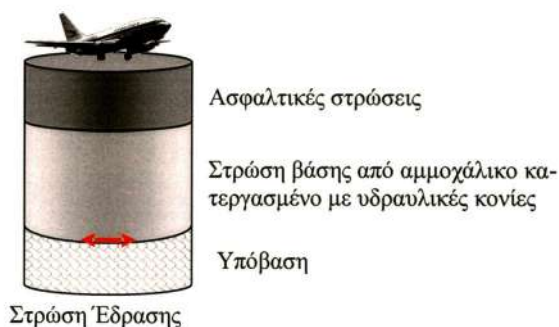
Σχήμα 3.16: Ενδεικτικό προσομοίωμα ημιακάμπτου οδοστρώματος αεροδρομίου.
