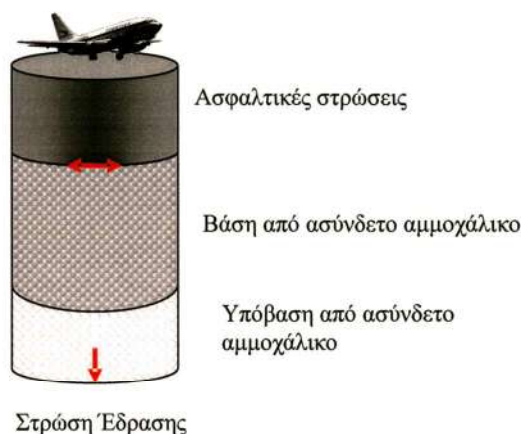
Σχήμα 2.4: Ενδεικτικό προσομοίωμα στρώσεων ασφαλικού οδοστρώματος αεροδρομίου με βάση από αμμοχάλικο (εύκαμπτο).
