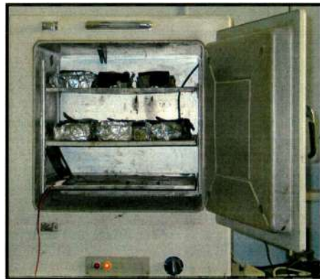
Φωτ. 4.4: Συντήρηση δοκιμίων που περιέχουν τσιμέντο με γαλάκτωμα (α μέσα στο υγρό θάλαμο, β. μέσα στο φούρνο)
