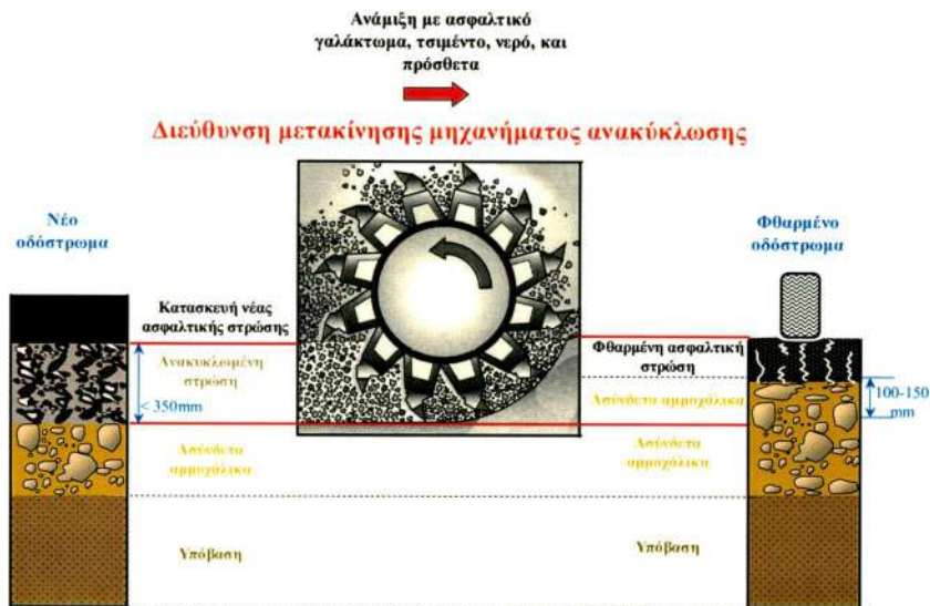
Σχήμα 2.1.: Ανακύκλωση στρώσης μεγάλου βάθους.
