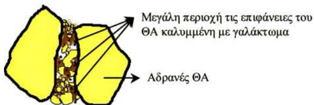
Σχήμα 6.25: μίγμα ΘΑ χωρίς τσιμέντο με μεγάλο ποσοστό γαλακτώματος
