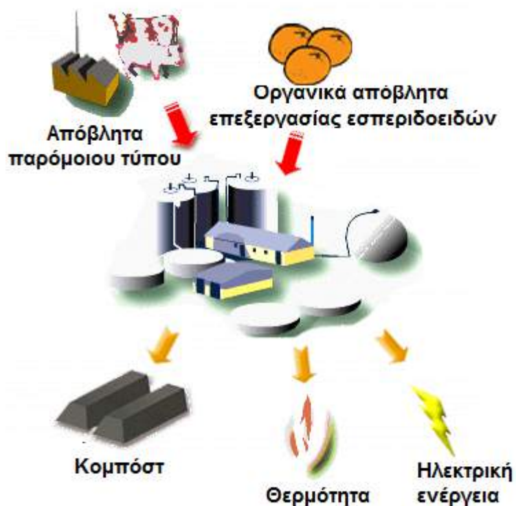
Εικόνα 74 Μονάδα αναερόβιας χώνευσης (Πηγή: ΚΑΠΕ AnDigNet)
