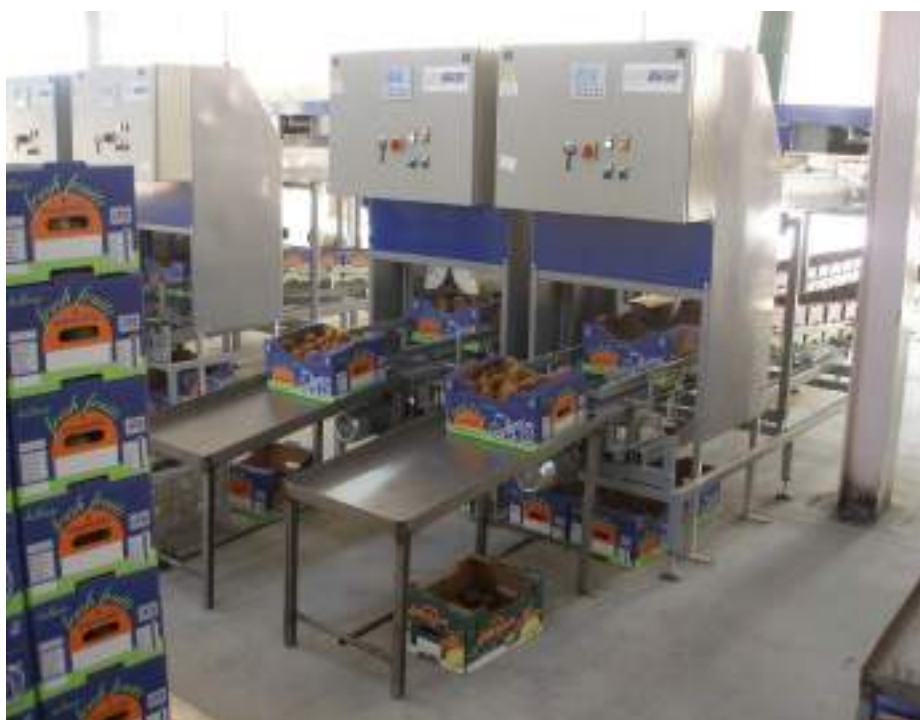
Εικόνα 49 Αυτόματο ζυγιστικό-κλειστικό χαρτοκιβωτίων ακτινιδίων (Πηγή: Novatec Α.Ε)
