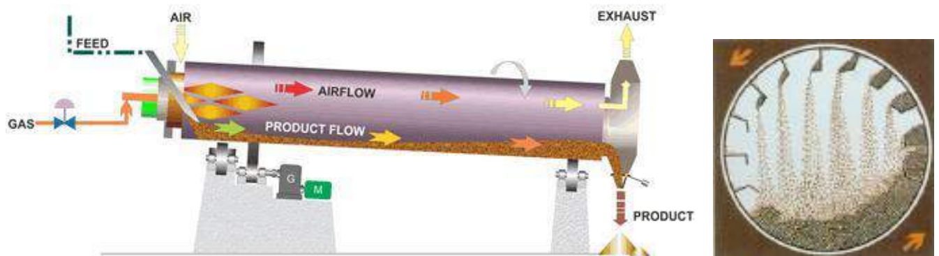
Εικόνα 68 Διάταξη περιστροφικού ξηραντήρα: κίνηση υλικού σε ομορροή με το θερμό αέρα (Αριστερά) – Ανυψωτική δράση πτερυγίων κατά την περιστροφή του κυλίνδρου (Δεξιά) (Πηγή: Tengda Machinery)
