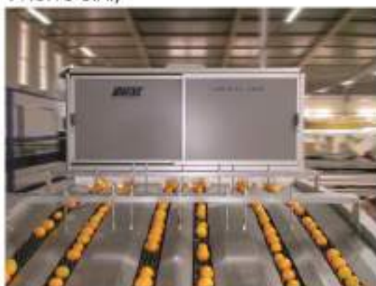
Ηλεκτρονικός Ταξινομητής Εσπεριδοειδών (Πηγή: NOVATEC A.E)
