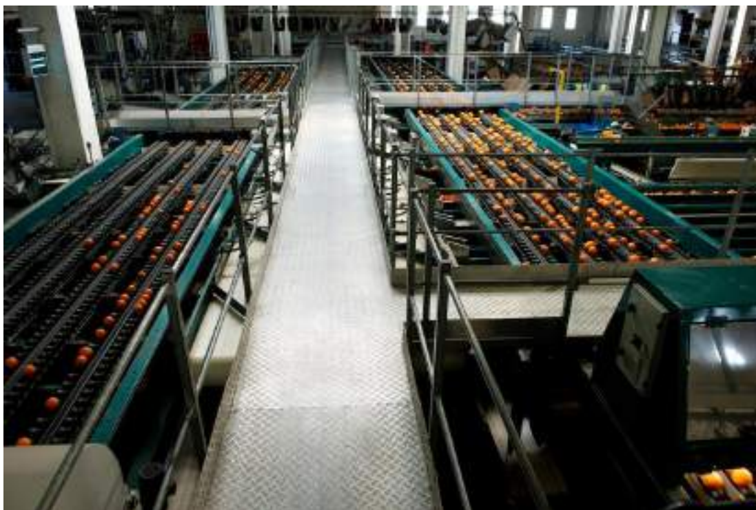
Εικόνα 42 Ηλεκτρονικός ταξινομητής (Καλιμπραδόρος) εσπεριδοειδών (Πηγή: PANTAZIS FRUITS S.A.)
