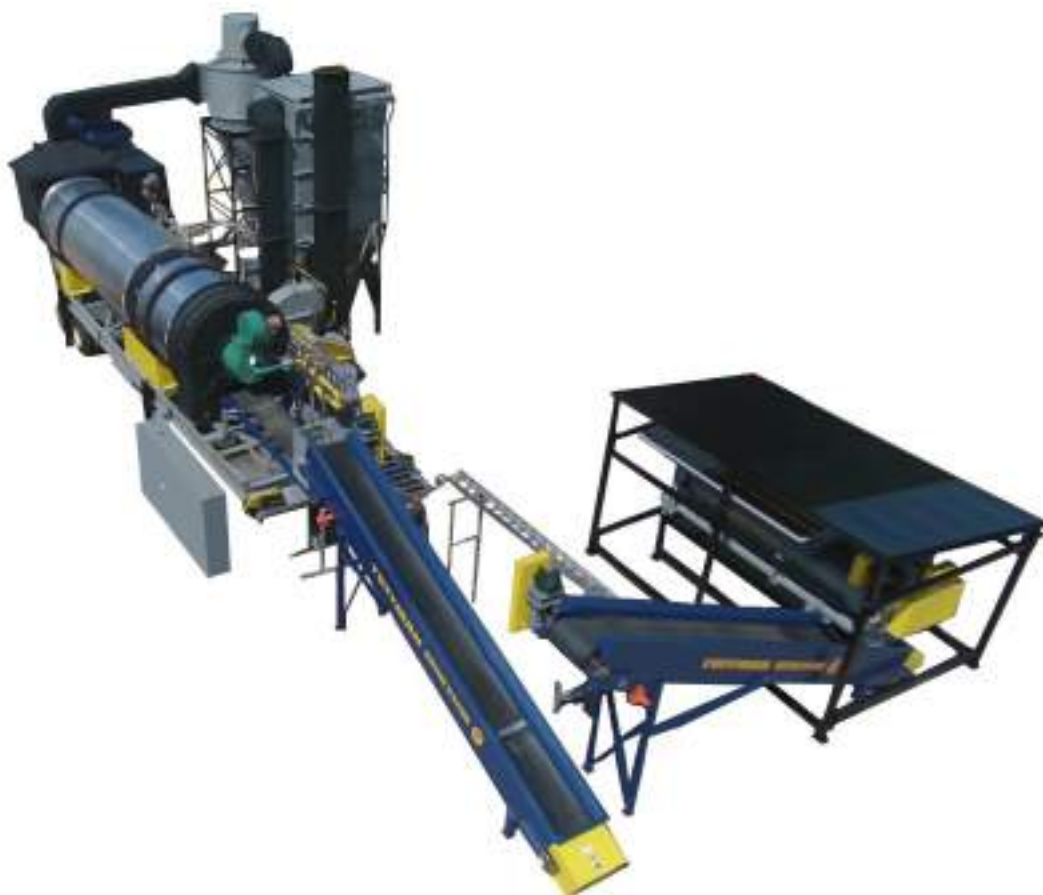
Εικόνα 71 Διάταξη ξηραντηρίου (Πηγή: Vulcan Systems)
