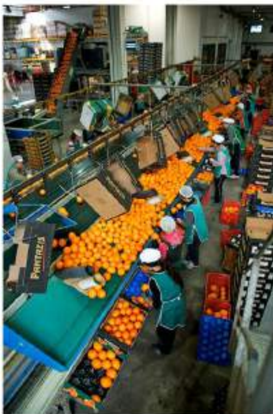
Τμήμα συσκευασίας εσπεριδοειδών με εναέρια γραμμή μεταφοράς άδειων χαρτακιβωτίων (Πηγή: PANTAZIS FRUITS S.A.)
