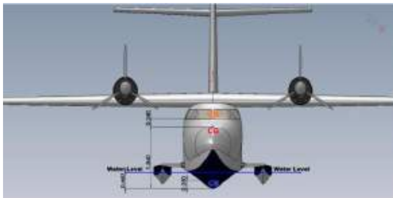
Εικόνα 3-25 CAD μοντέλο υδροπλάνου Trimaran σε εγκάρσια όψη που δείχνει: μετάκεντρο, κέντρο βάρους και άντωσης (CAD Model of Trimaran Seaplane at Transverse showing Metacenter, Centre of Gravity, and Buoyancy) Πηγή: [2]
