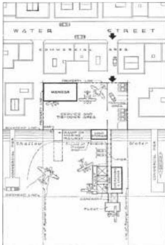
Εικόνα 3-45 Τυπική διάταξη ανάπτυξης ακτής και ακτογραμμής (Typical Layout of On-Shore and Shore-Line Development) Πηγή: [11]
