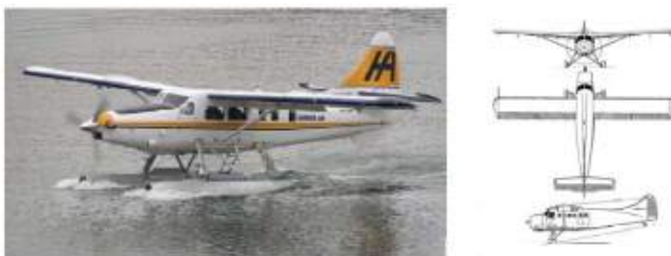
Εικόνα 3-14 Photo Φωτογραφίες και τρισδιάστατη όψη DHC-3 (Photo and 3-view of the DHC-3) Πηγή: [3]
