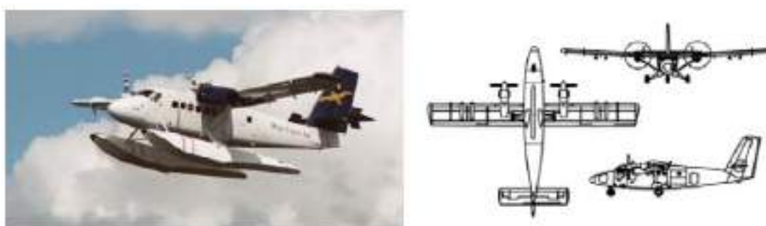
Εικόνα 3-15 Φωτογραφίες και τρισδιάστατη όψη DHC-6 (Photo and 3-view of the DHC-6) Πηγή: [3]
