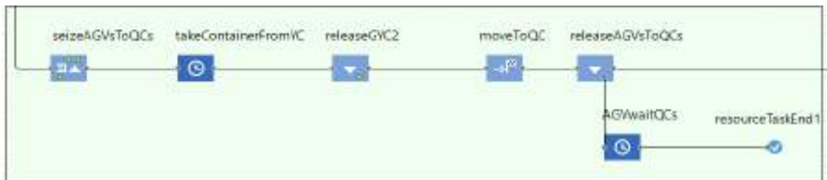
Εικόνα 96 Διαδικασία φόρτωσης πλοίων διάγραμμα ροής
