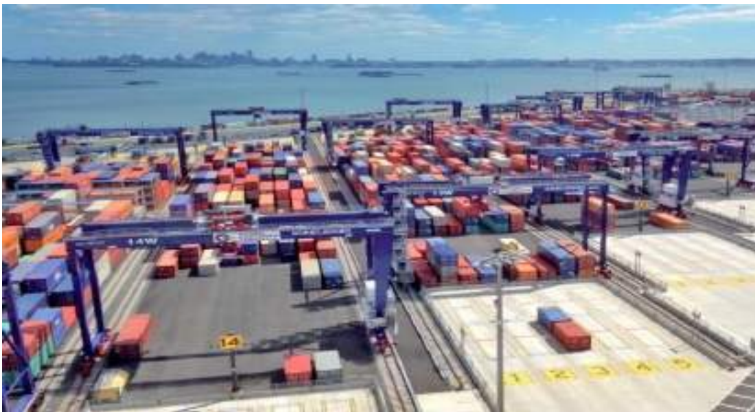
Εικόνα 12 Γερανογέφυρες επί σιδηροτροχιών [Πηγή: KoneCranes, http://www.konecranes.com ]
