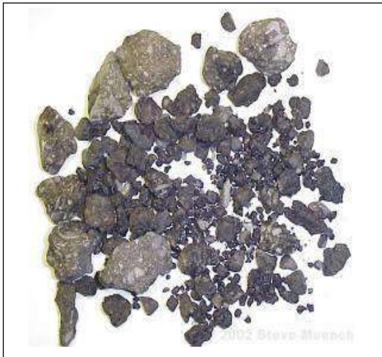
Εικόνα 2.1 Ανακτώμενο ασφαλτικό υλικό
