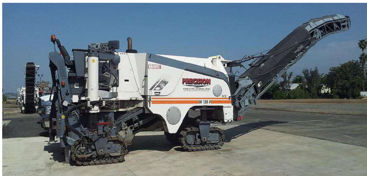
Εικόνα 2.2 Ειδικό όχημα για milling οδοστρωμάτων
