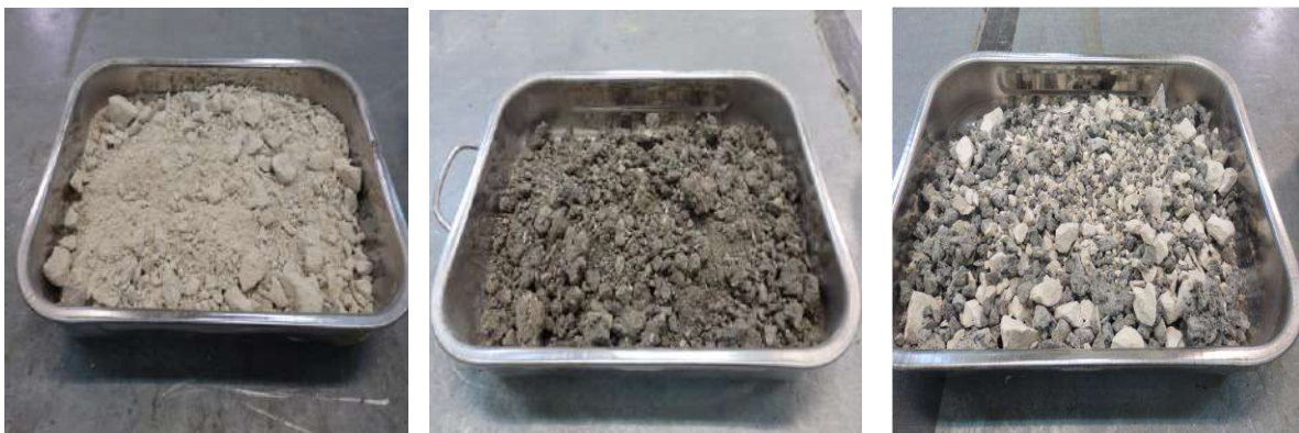
Εικόνα 5.1 Από αριστερά προς δεξιά: αδρανές υλικό 3Α, ανακτώμενο ασφαλικό υλικό και μίγμα των δύο υλικών
