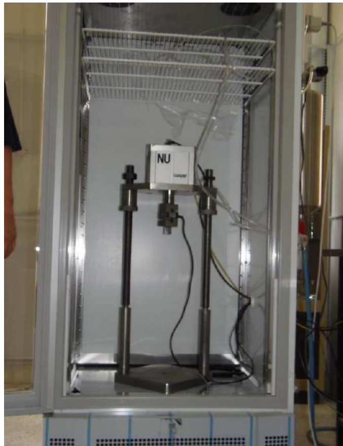
Εικόνα 4.3 Θάλαμος τριαξονικής δοκιμής φόρτισης
