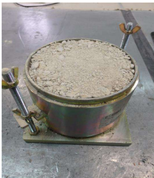
Εικόνα 4.2 Στρώση αδρανούς υλικού σε μήτρα συμπύκνωσης
