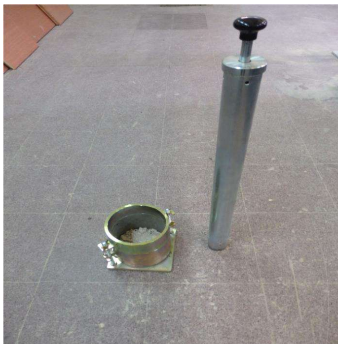
Εικόνα 4.1 Μήτρα και κόπανο τροποποιημένης δοκιμής Proctor
