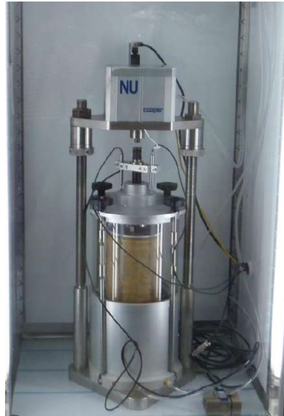
Εικόνα 4.6 Δοκίμιο πριν και αφού τοποθετηθεί στον θάλαμο φόρτισης
