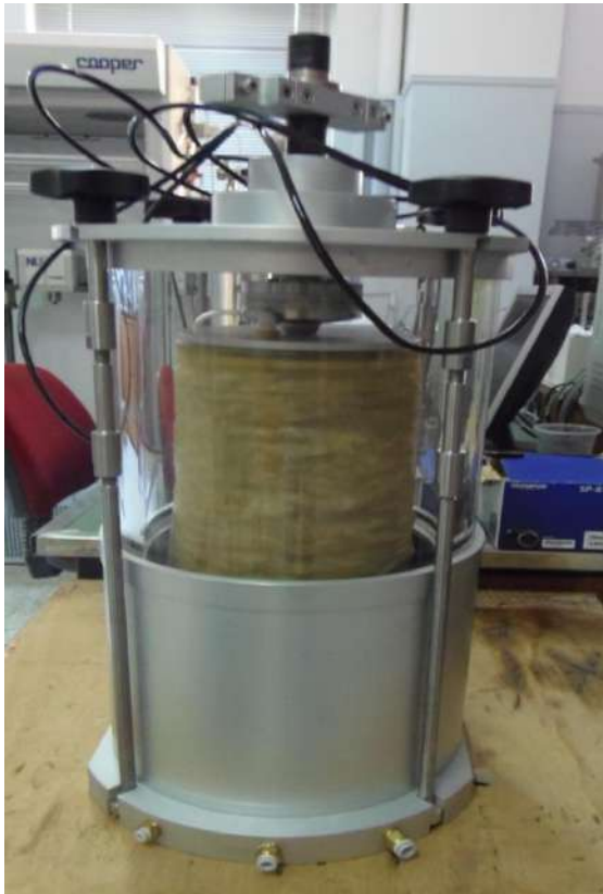
Εικόνα 4.6 Δοκίμιο πριν και αφού τοποθετηθεί στον θάλαμο φόρτισης
