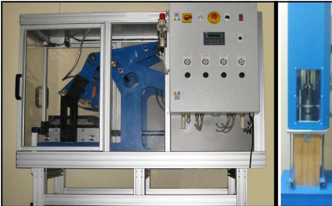
Σχήμα 3.2 Εργαστηριακή συσκευή συμπίκνωσης μεθόδου Roller (αριστερά) και Marshall (δεξιά)
