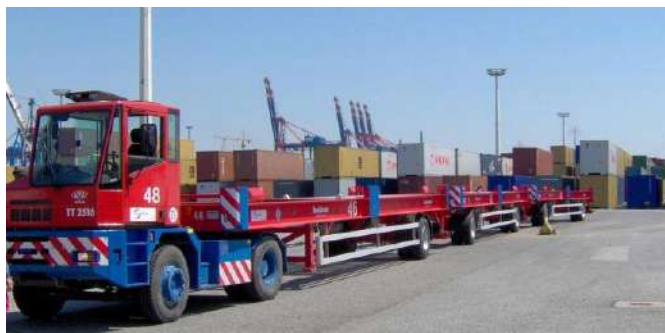
Εικόνα 1. 6: Ελκυστήρας με δυνατότητα ρυμούλκησης πολλών τρέιλερ. Πηγή: [2]
