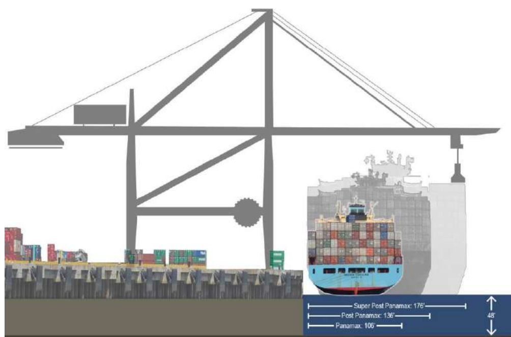
Εικόνα 1. 3: Τύποι γερανογεφυρών κρηπιδώματος. Πηγή: [3]
