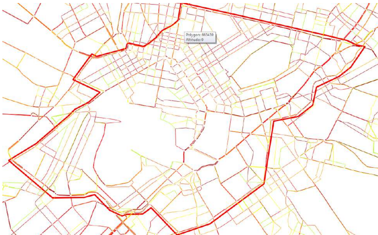
Σχήμα 5.13 Χάρτης συντελεστή V/C οδών σεναρίου Γ
