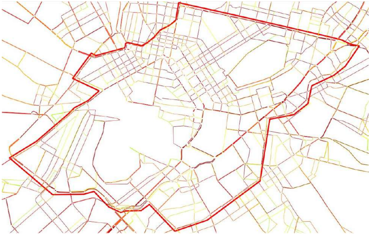
Σχήμα 5.7 Χάρτης συντελεστή V/C οδών βασικού σεναρίου.
