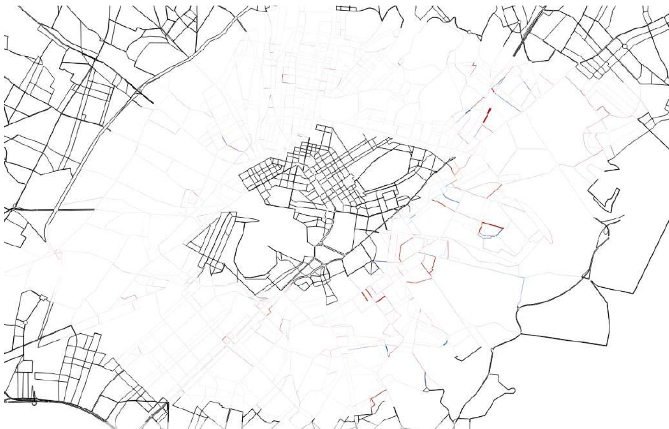
Σχήμα 6.1 Χάρτης σύγκρισης συντελεστή V/C μεταξύ σεναρίου Γ και Δ για τις οδούς περιφερειακά του δακτυλίου
