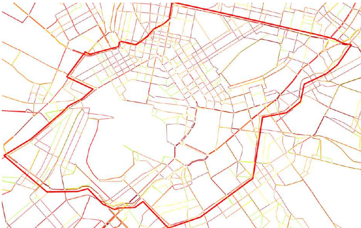
Σχήμα 5.11 Χάρτης συντελεστή V/C οδών σεναρίου Β
