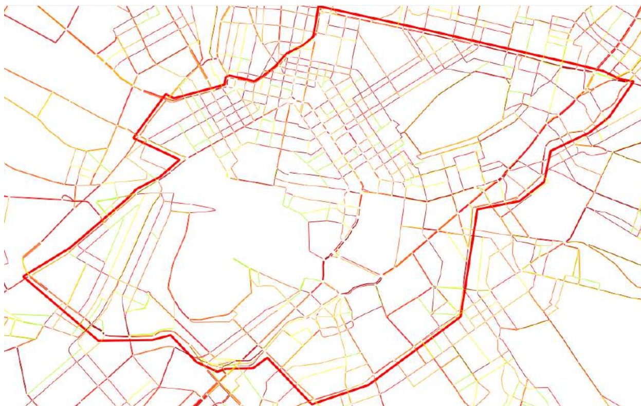
Σχήμα 5.15 Χάρτης συντελεστή V/C οδών σεναρίου Δ
