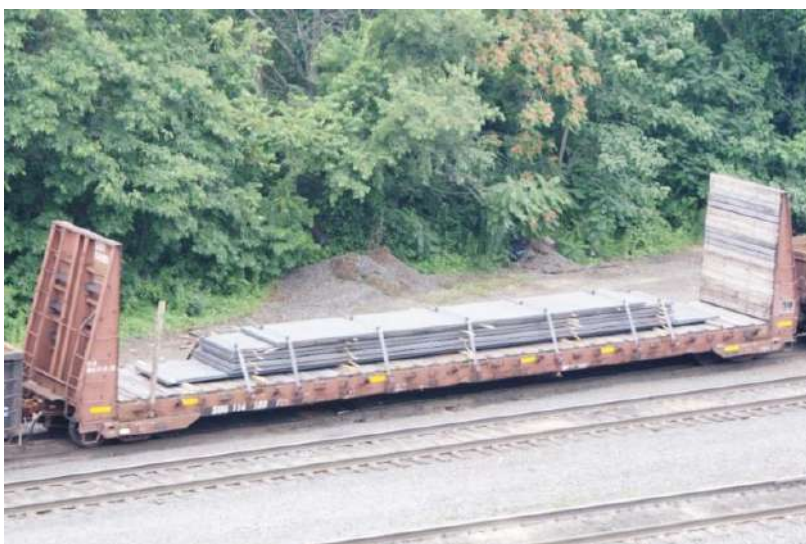
Εικόνα 49: Μεταφορά πλακών χάλυβα από βαγόνι πλατφόρμα [85]
