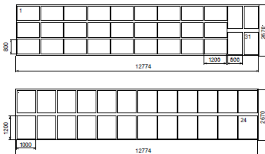
Εικόνα 47: Διάταξη ευρωπαϊκών σε κλειστό βαγόνι [84]
