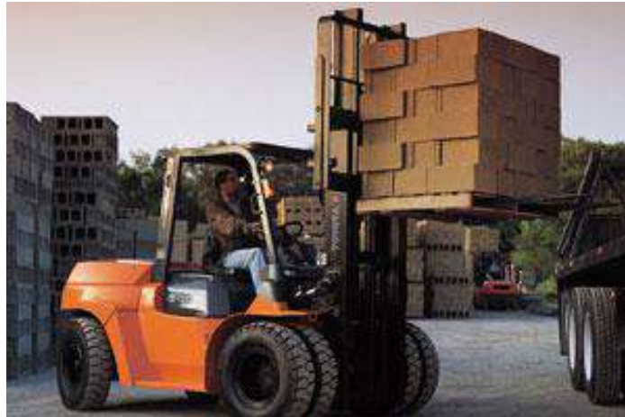
Εικόνα 58: Περονοφόρο με αντίβαρα μεταφέρει κιβώτια σε παλέτα [95]
