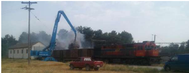
Εικόνα 65: Φόρτωση χύδην φορτίου σε βαγόνι υψηλών παρειών [100]
