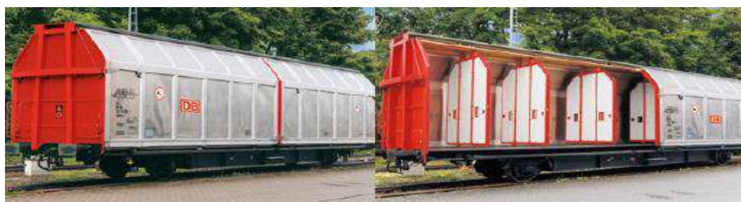
Εικόνα 46: Κλειστό βαγόνι με ασφαλιζόμενα διαχωριστικά [84]
