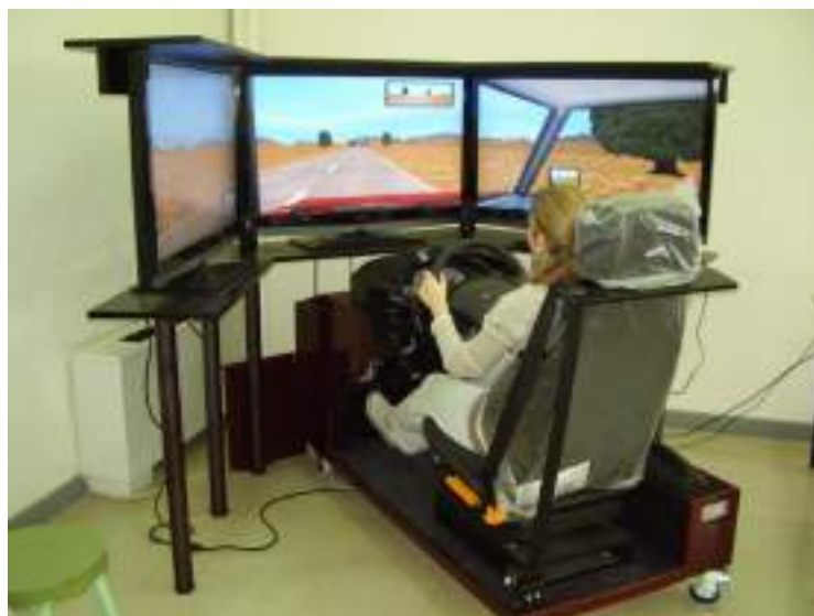
ΕΙΚΟΝΑ 1 : Φωτογραφία του προσομοιωτή οδήγησης (Driving Simulator FPF).
