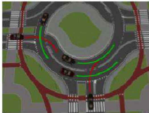
Εικόνα 3.14 Εμπλοκή διασταύρωσης κατά την είσοδο οχημάτων στον σπειροειδή κυκλικό κόμβο. Έχει προκύψει από σχετική έρευνα πως προκαλείται αίσθηση ανασφάλειας στους οδηγούς (Tollazzi et al., 2011).
