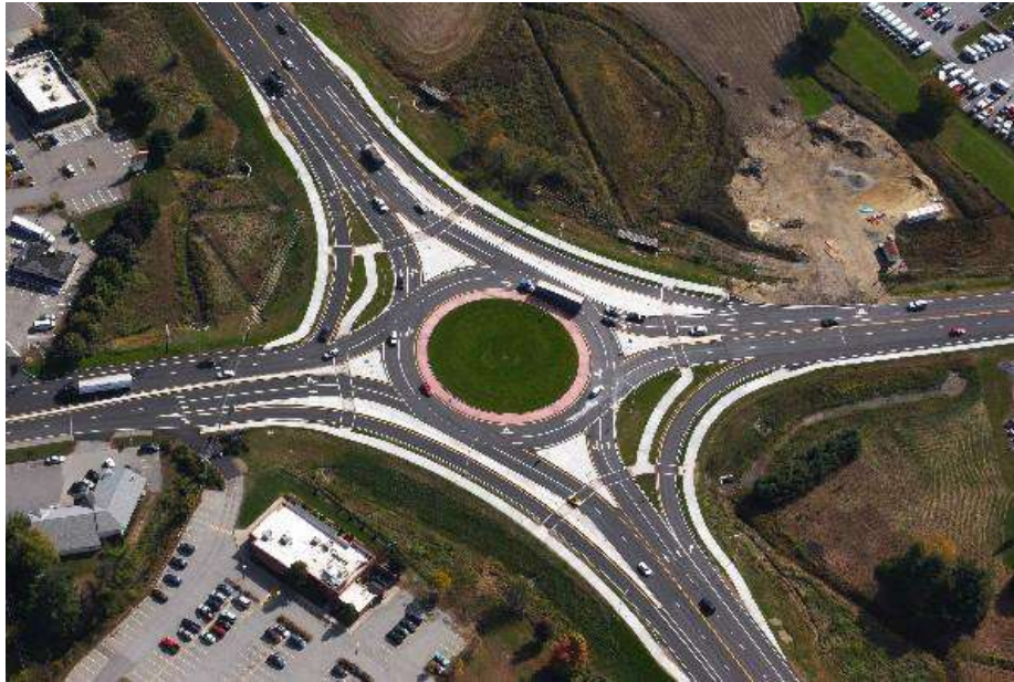
Εικόνα 3.9 Τετρασκελής κυκλικός κόμβος δύο λωρίδων με τέσσερις παρακαμπτήριες λωρίδες ( http://www.roundaboutsusa.com ).
