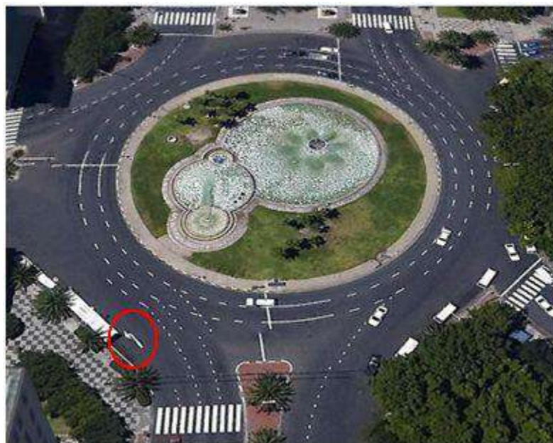
Εικόνα 3.13 Κυκλικός Κόμβος Τριών Λωρίδων (Multi-Lane Roundabout) ( http://k53.gavinhoole.ws ).
