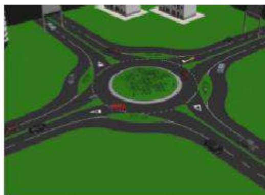
Εικόνα 3.15 Κυκλικός Κόμβος τύπου «Άνθος» (Tollazzi et al., 2011).
