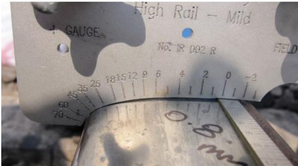
Εικόνα 2.4: Όργανο μέτρησης κυματώσεων σιδηροτροχιάς [9]
