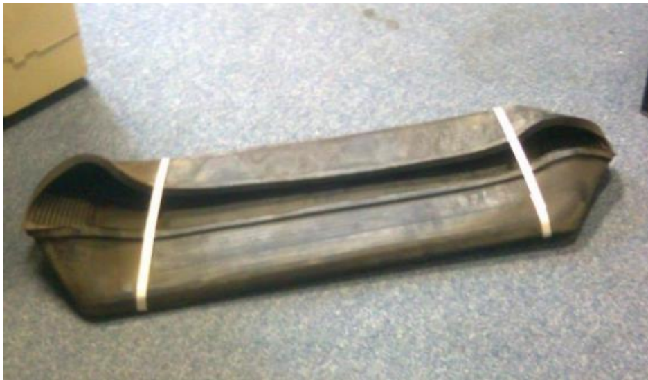
Εικόνα 2.3: Ελαστικό περίβλημα στρωτήρων (ελαστική «μπότα») [7]
