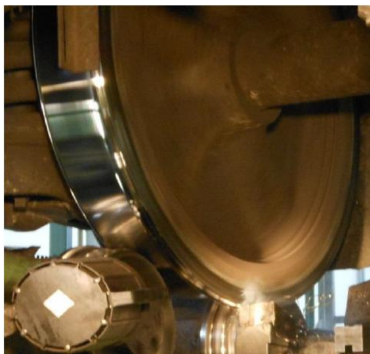
Εικόνα 2.16: Τροχός κατά τη διαδικασία της τήννωσης [21]
