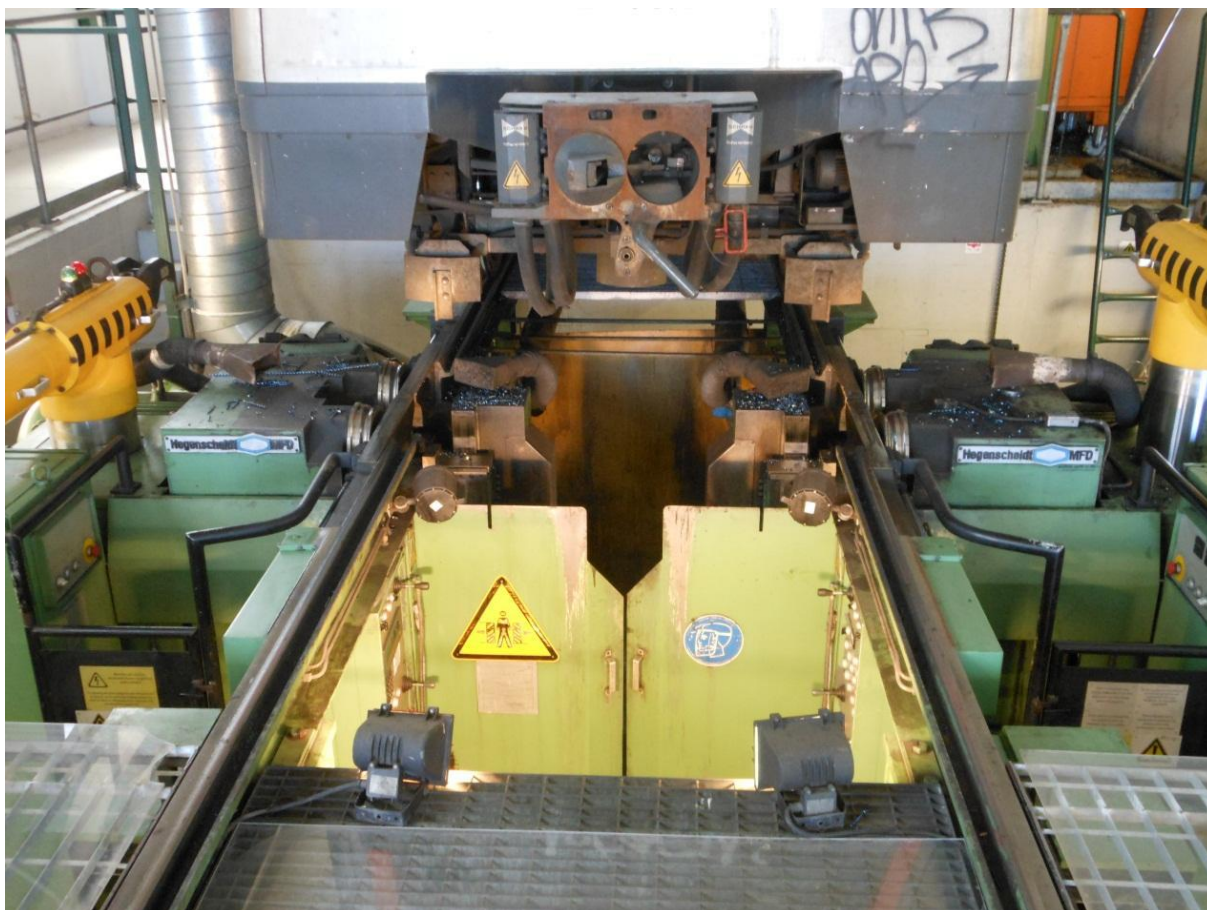
Εικόνα 2.15: Φωτογραφία τήνου στο αμαξοστάσιο της Α.Μ.Ε.Λ. στα Σεπόλια [21]
