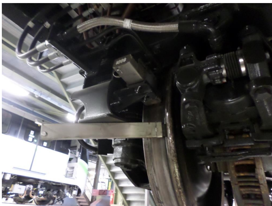
Εικόνα 5.4: Βελτιωτικό τριβής επί σιδηροδρομικού οχήματος τρίτης γενιάς του Μετρό Αθηνών
