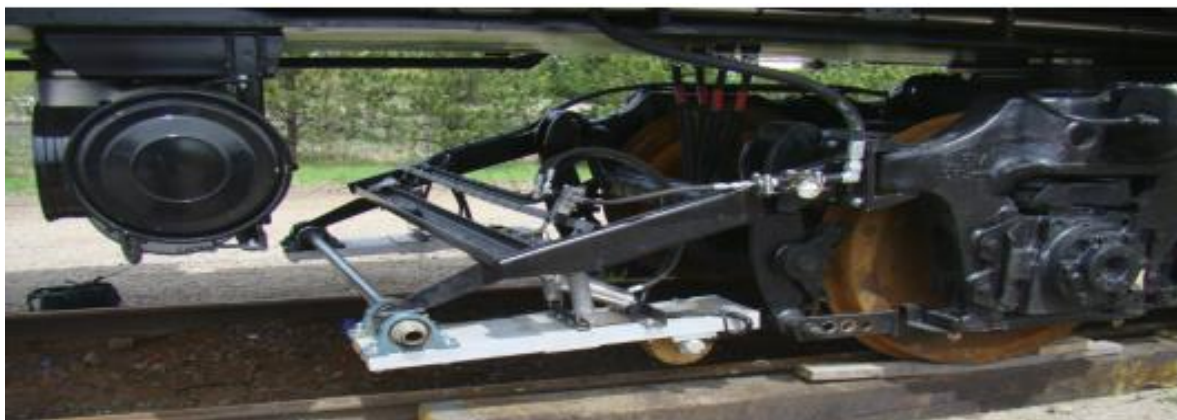
Εικόνα 2.5: Φορείο με κατάλληλο εξοπλισμό για τη μέτρηση των κυματώσεων της σιδηροτροχιάς [9]
