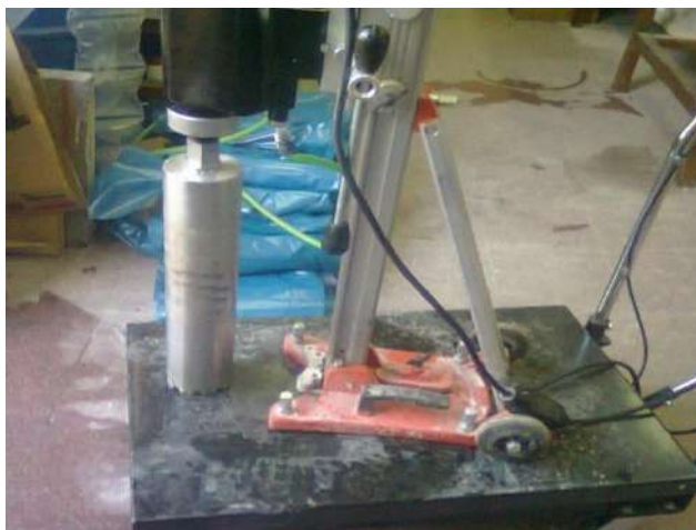
Εικόνα 3.10: Πυρηνοληψία δοκιμών με καροταρία
