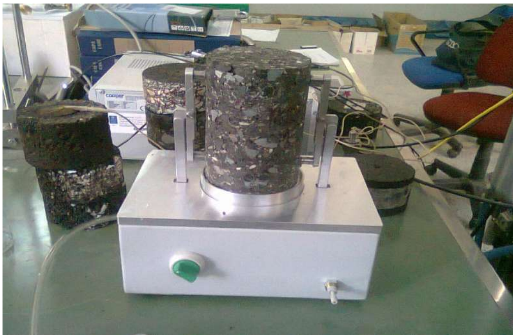
Εικόνα 4.4 : Συσκευή CRT-SPLTV για την ενσωμάτωση μεταλλικών βάσεων στο δοκίμιο όπου θα τοποθετηθούν τα LVDT's στην εργαστηριακή δοκιμή του E*
