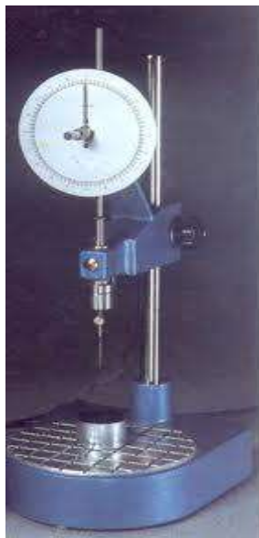
Εικόνα 3.4: Διάταξη δοκιμή διείσδυσης
