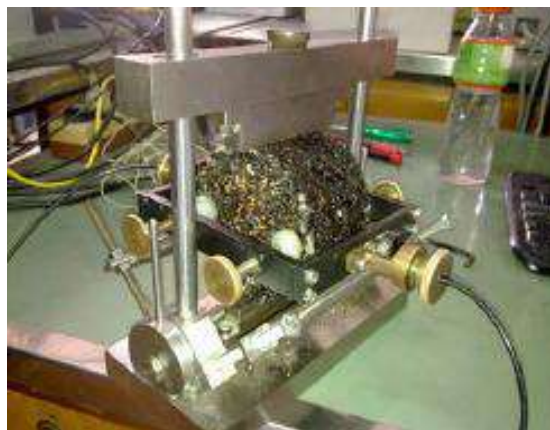
Εικόνα 4.2 : Τοποθέτηση δοκιμίου στο υποπλαίσιο
