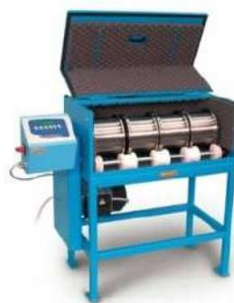
Εικόνα 2.9: Συσκευή δοκιμής Deval
