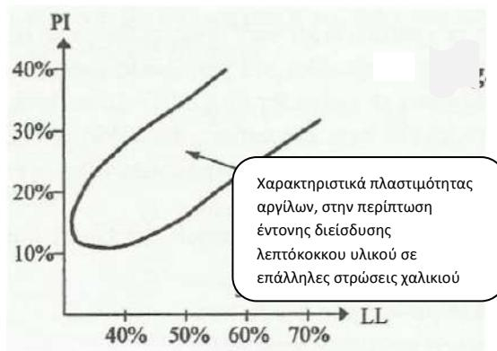
Σχήμα 1.5: Χαρακτηριστικά πλαστιμότητας αργίλων, στην περίπτωση έντονης διείσδυσης λεπτόκοκκου υλικού σε επάλληλες στρώσεις χαλικιού.
