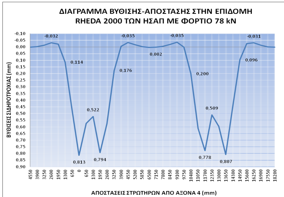
Διάγραμμα 5.3 Βύθισεις σιδηροτροχιάς στην επιδομή των ΗΣΑΠ με φορτίο 78 kN.
