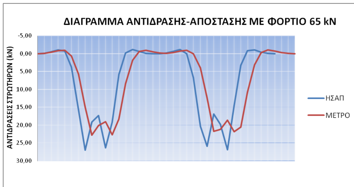
Διάγραμμα 5.10 Αντιδράσεις στρωτήρων με φορτίο 65 kN.
