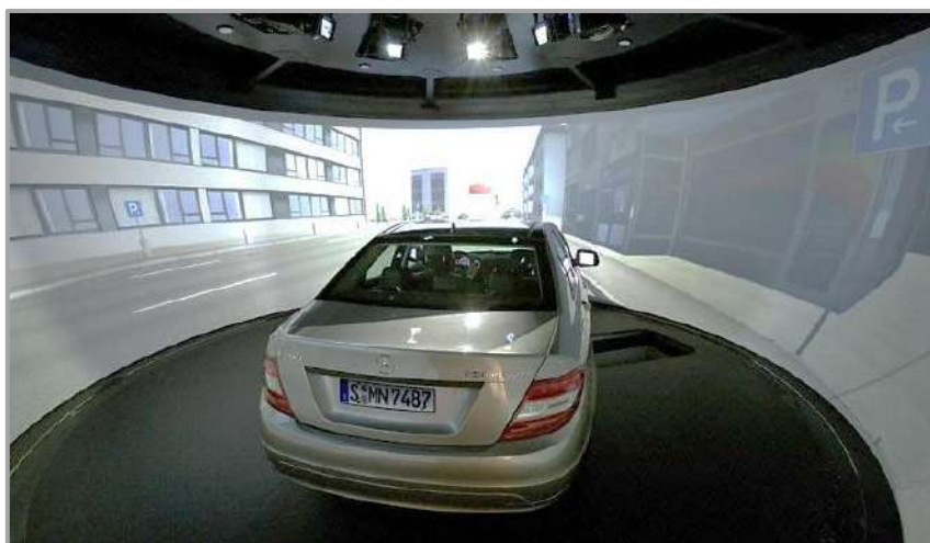
Εικόνα 1.4: Προσομοιωτής οδήγησης στις εγκαταστάσεις της εταιρείας Mercedes-Benz, ο οποίος χρησιμοποιείται για ερευνητικούς σκοπούς. (Πηγή: Autozine: O simulador high-tech da Mercedes-Benz – http://autozine.com.br )
