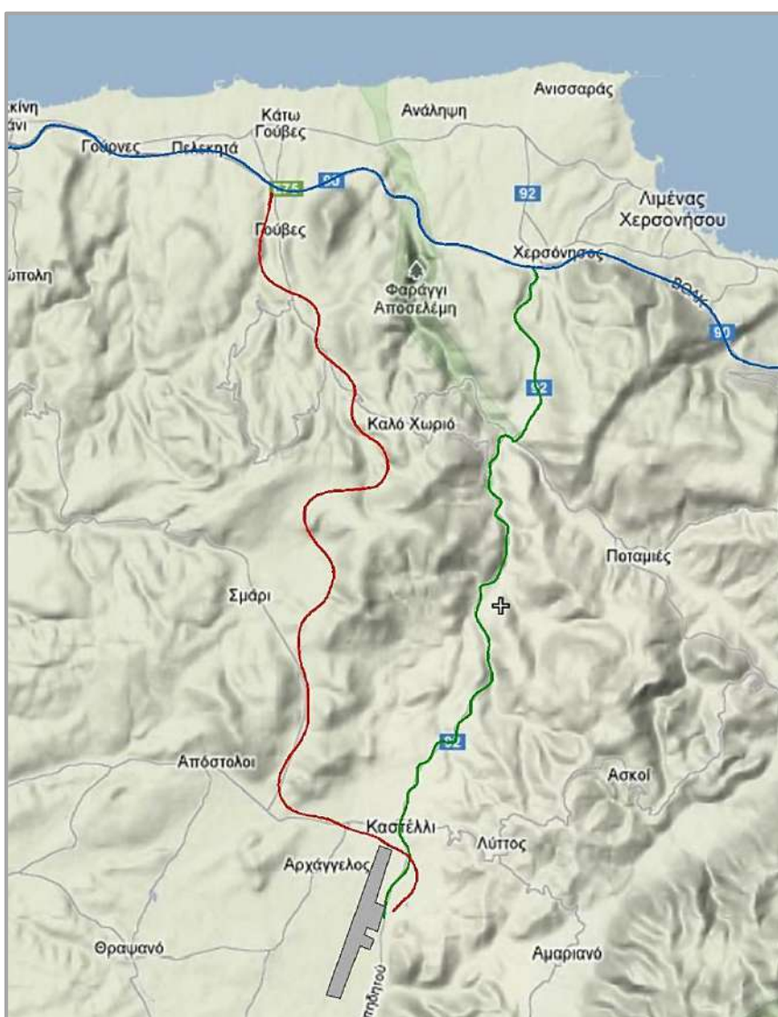
Εικόνα 6.1: Χάρτης της περιοχής μελέτης του παραδείγματος. Με κόκκινο χρώμα παρουσιάζεται η προτεινόμενη χάραξη με χρήση καμπύλης NURBS. Με μπλε χρώμα σημειώνεται η Εθνική Οδός Ηρακλείου – Λασιθίου και με πράσινο χρώμα σημειώνεται η υπάρχουσα οδός που σύνδεσης του αεροδρομίου με την Εθνική Οδό. (Πηγή χάρτη: Χάρτες Google – http://maps.google.com )
