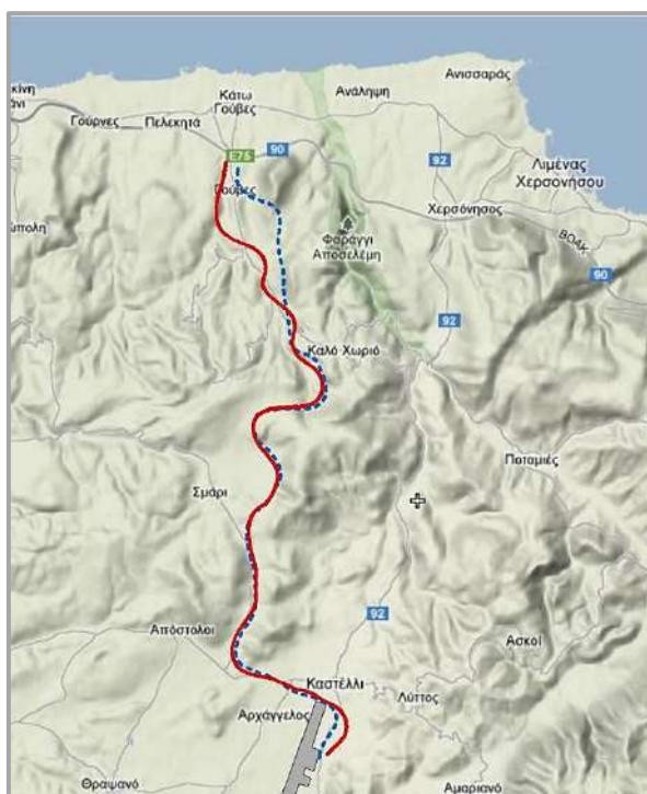
Εικόνα 6.7: 3 η δοκιμαστική χάραξη. Με διακεκομμένη γραμμή σημειώνεται η προηγούμενη (2 η ) δοκιμαστική χάραξη. (Πηγή χάρτη: Χάρτες Google – http://maps.google.com )
