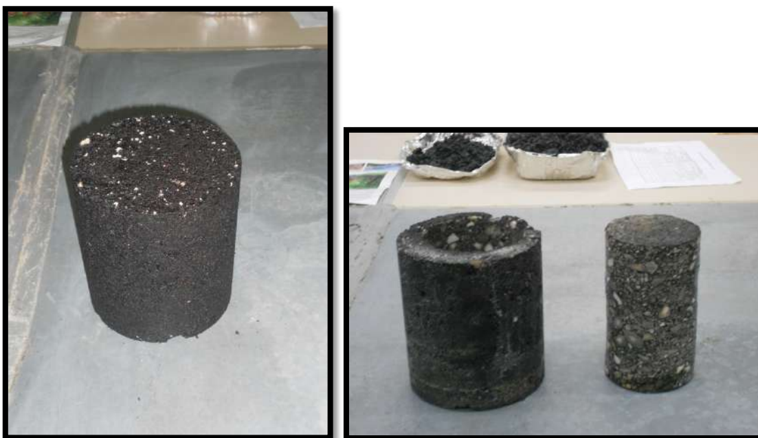
Εικόνα 5.2. Μορφή δοκιμίου από τη γυροσκοπική μέθοδο και μορφή δοκιμίου μετά την απόσπαση καρδίου από το εσωτερικό του.
