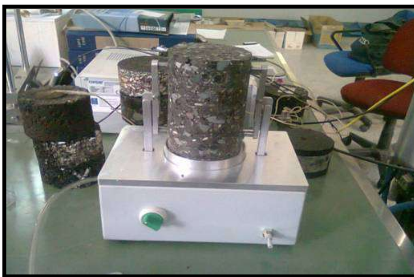
Εικόνα 6.2. Ειδική συσκευή προσάρτησης μεταλλικών βάσεων στο δοκίμιο
