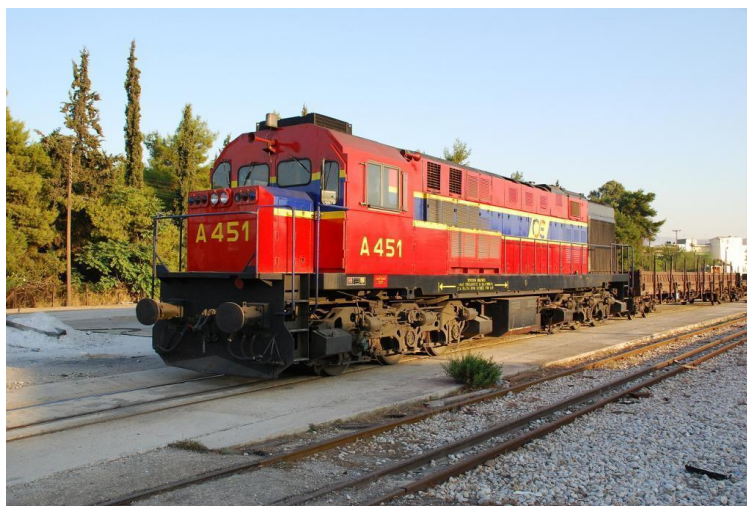
Εικόνα 10: Ντιζελομηχανή της σειράς 450 με ισχύ 1985 kW (πηγή: www.amnizia.org )
