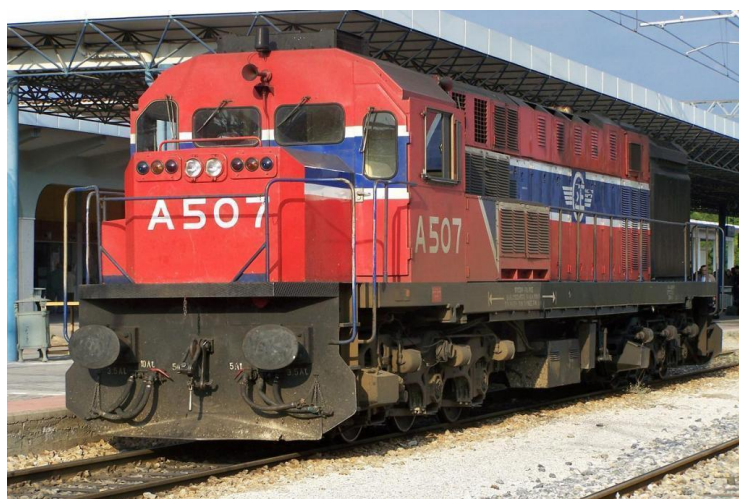
Εικόνα 11: Ντιζελομηχανή της σειράς 500 με ισχύ 2600 kW (πηγή: www.amnizia.org )
