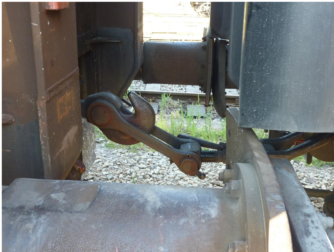
Εικόνα 14: Διάταξη ζεύξης μιας εμπορευματικής φορτάμαξας
