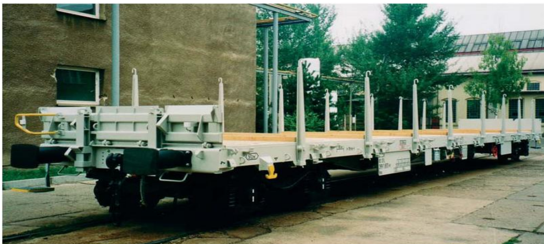
Εικόνα 36: Επίπεδη φορτάμαξα τύπου 1 κατά UIC (Rns) (Πηγή www.legios.eu )
