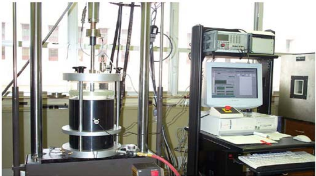
Εικόνα 4.6: Σύστημα τριαξονικής δοκιμής (Zhou and Scullion, 2005)
