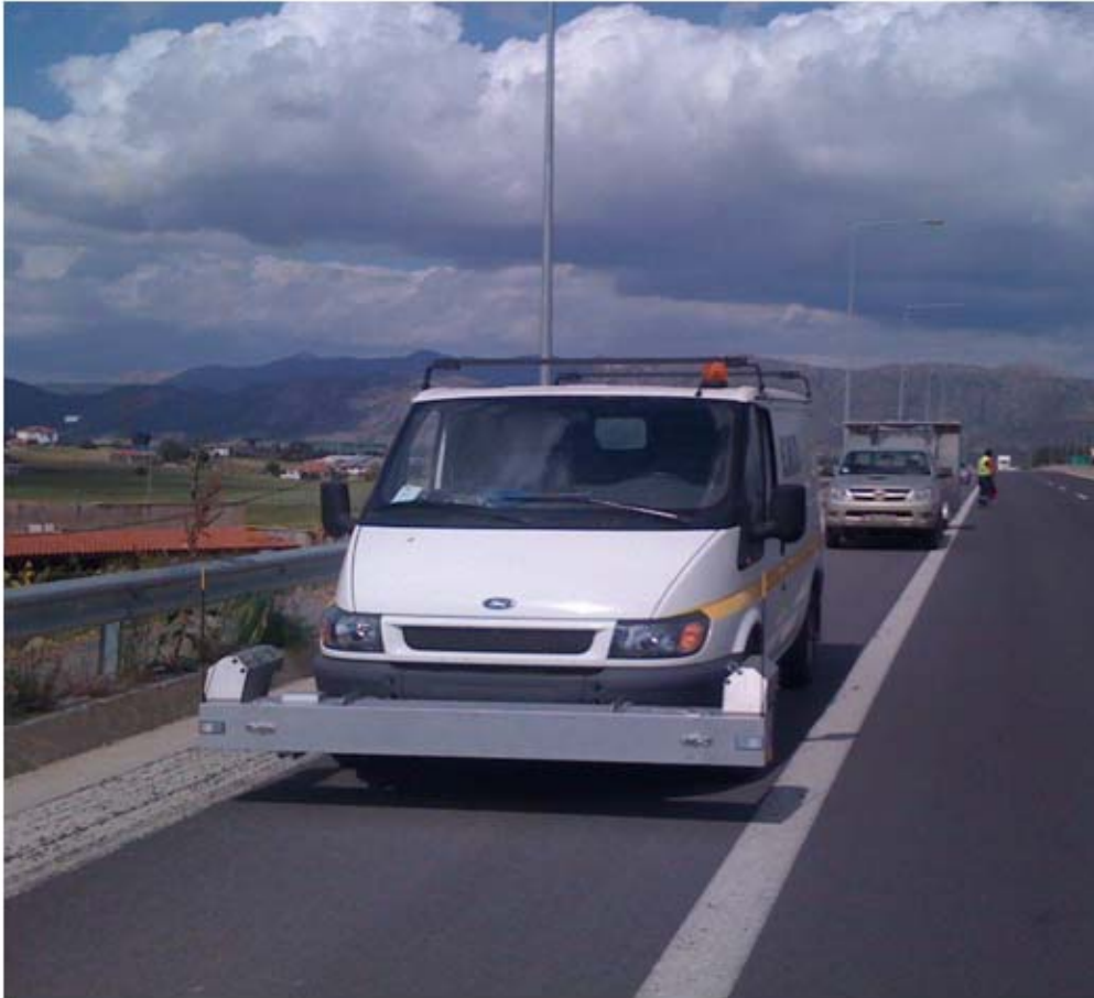
Εικόνα 5.12: Laser Profiler του Εργαστηρίου Οδοποιίας ΕΜΠ
