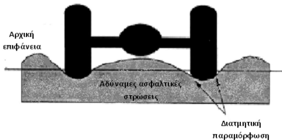
Εικόνα 2.8: Τροχοαλάκωση λόγω αδύναμων ασφαλτικών στρώσεων (Garba, 2002)
