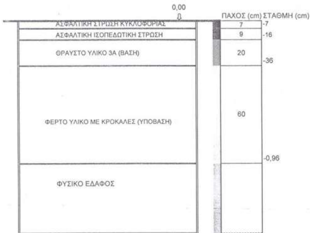
Σχήμα 2.5: Ερευνητική τομή νότιου Π/Τ πριν από την ανακατασκευή του
