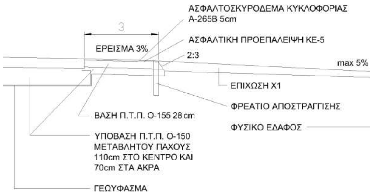
Σχήμα παραρτήματος 2.3: Διατομή δύσκαμπτου τμήματος κυρίως Δ/Π
