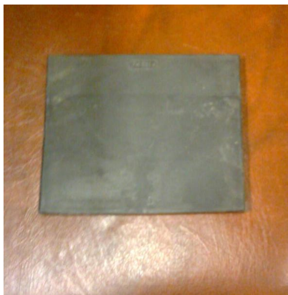
Εικόνα 1.3 : Rail pad (ελαστικό υπόθεμα κάτω από τη σιδηροτροχιά)
