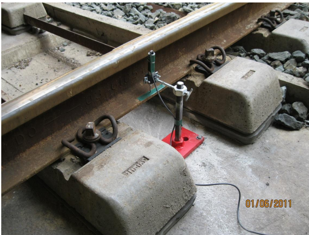
Εικόνα 4.11: Τοποθέτηση μηκυνσιομέτρου 1 (δοκιμαστικές μετρήσεις)
