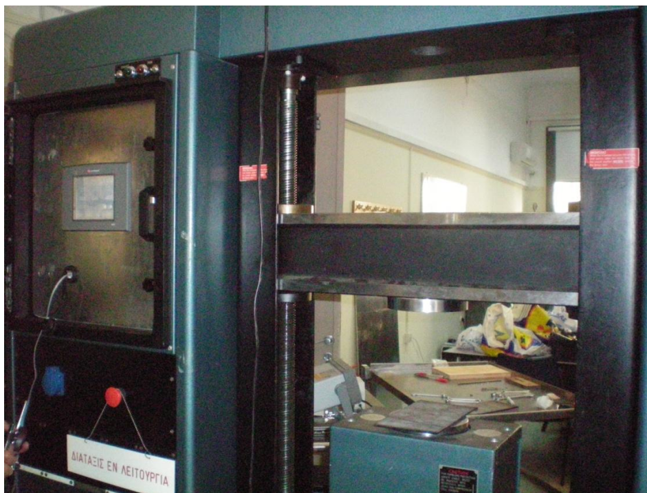
Εικόνα 5.1: Electro-mechanical loading frame INSTRON 1125, 50kN
