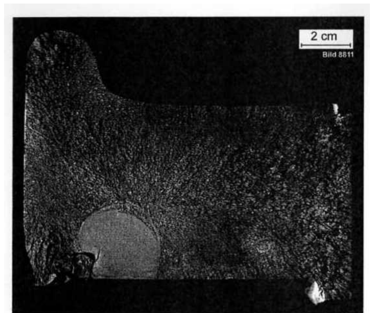
Εικόνα 2.19: Ανοιγμένη οπή, ρηγμάτωση επισώτρου [6]
