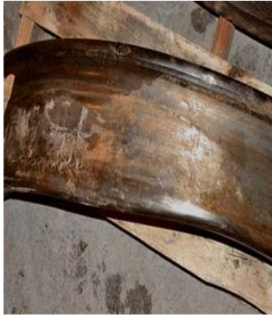
α) Πλαστική παραμόρφωση στην επιφάνεια κυλίσεως του τροχού
