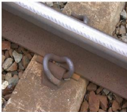
γ) Κόπωση εξ επαφής κατά την κύλιση στη σιδηροτροχιά, εστίαση στη γωνία αναφοράς της σιδηροτροχιάς
