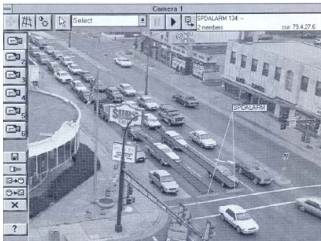
Εικόνα 9 : Μορφή εικόνας του Autoscope με ανιχνευτές (Πηγή : Autoscope User Manuals,1998)
