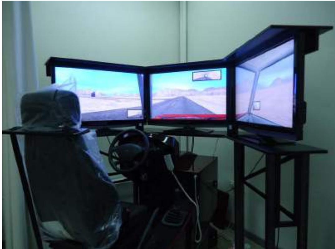
Εικόνα 4.1: Προσομοιωτής οδήγησης (Driving Simulator PFF)
