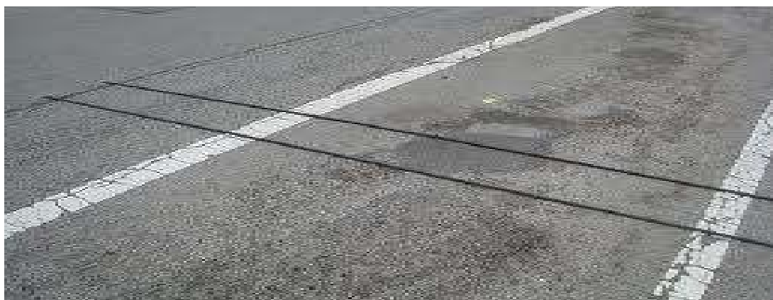
Εικόνα 7.1.Μετρητής με πεπιεσμένο αέρα
