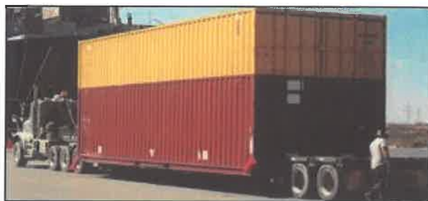
Σχήμα 2.1.13: Εμπορευματοκιβώτιο πλάτους γενικού σκοπού πλάτους 10' Πηγή: (1)
