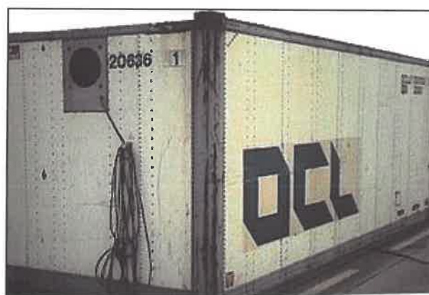
Σχήμα 2.1.16: Εμπορευματοκιβώτιο γενικού σκοπού με μηχανικό εξαερισμό εγκατεστημένο σε αυτό Πηγή: (1)
