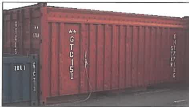
Σχήμα 2.1.11: Εμπορευματοκιβώτιο 20'x8'6" με πόρτες στα δύο άκρα Πηγή: (1)
