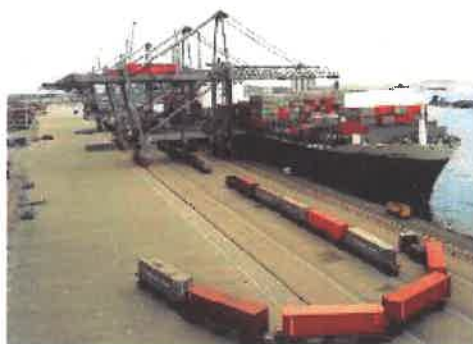
Σχήμα 3.2.3: Ελκυστήρας μεταφοράς δύο ή περισσότερων βάσεων
