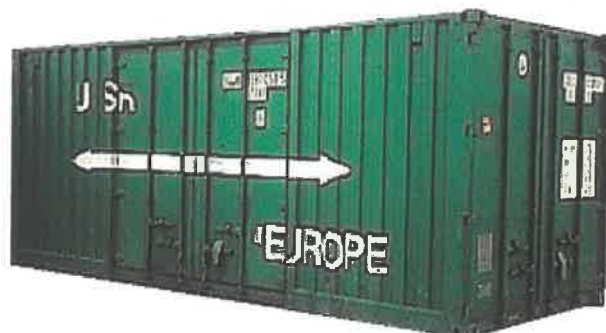
Σχήμα 2.1.9: Εμπορευματοκιβώτιο 20'x8'6" με πλευρικές πόρτες. Πηγή: (1)
