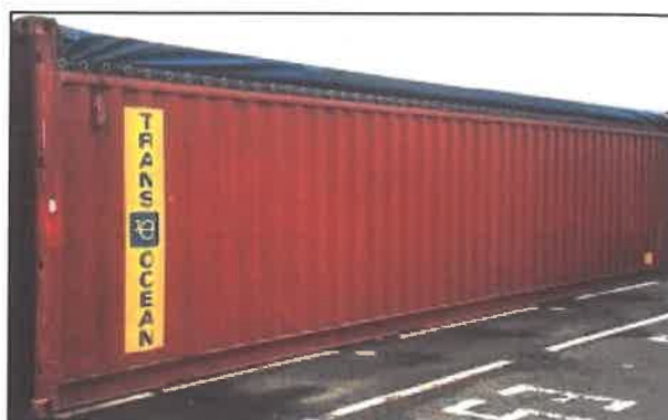
Σχήμα 2.1.30: Εμπορευματοκιβώτιο ανοικτής οροφής με κάλυμμα και τοξωτά πλαίσια
