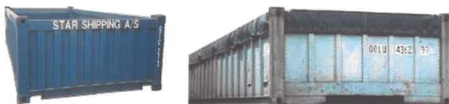
Σχήμα 2.1.32: Εμπορευματοκιβώτια ανοικτής 20' και 40', με και χωρίς κάλυμμα Πηγή: (1)
