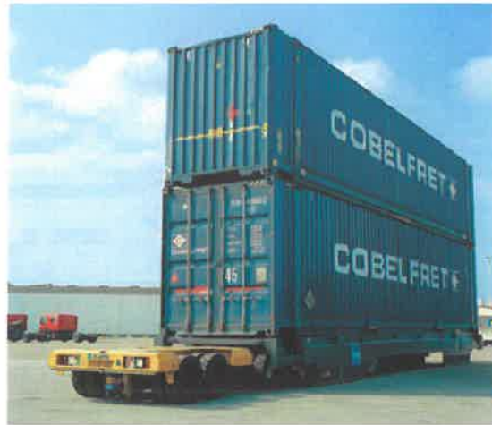
Σχήμα 3.2.10: Σύστημα cassette AGV Πηγή: (13)
