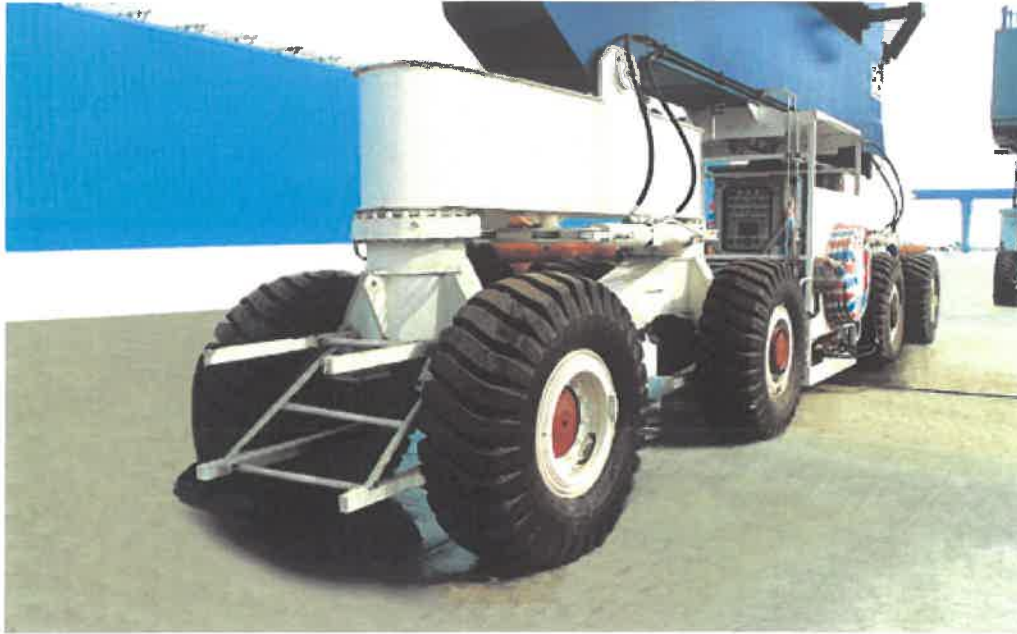
Σχήμα 3.3.9: Γερανογέφυρα RTG με 16 τροχούς Πηγή: (17)
