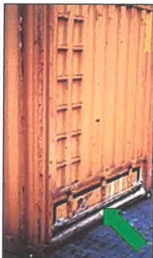
Σχήμα 2.1.18: Εμπορευματοκιβώτιο ξηρού χύδην φορτίου με θυρίδα εκκένωσης Πηγή: (1)
