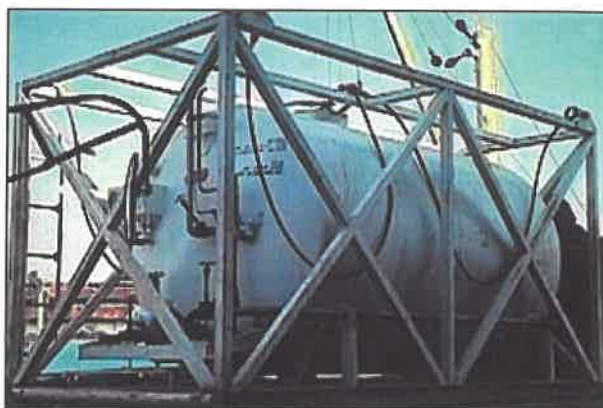
Σχήμα 2.1.36: Εμπορευματοκιβώτιο-βυτίο μεταφοράς μη επικίνδυνων υγρών Πηγή: (1)
