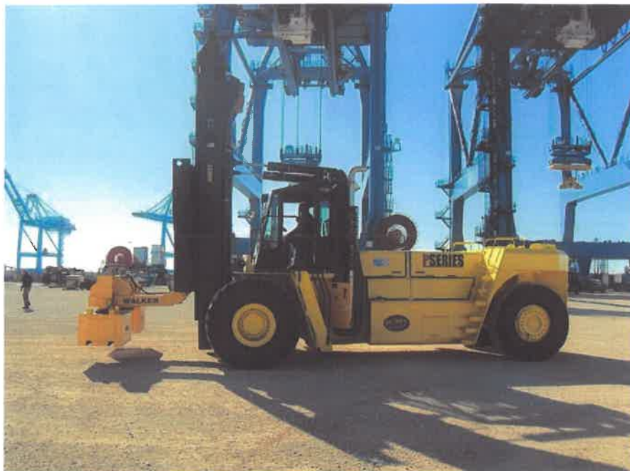
Σχήμα 3.4.4: Περονοφόρο ανυψωτικό όχημα (forklift truck) μεταφοράς εμπορευματοκιβωτίων
