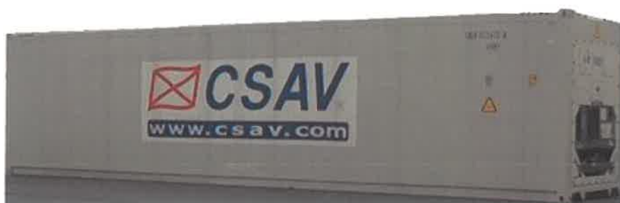
Σχήμα 2.1.24: Θερμικό εμπορευματοκιβώτιο με ενσωματωμένη μονάδα ψύξης Πηγή: (1)
