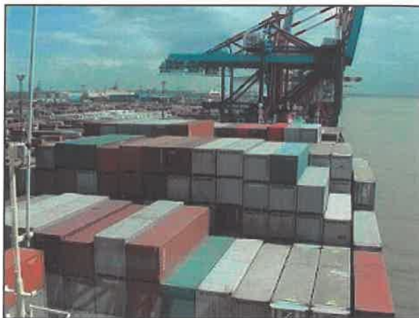
Σχήμα 2.2.12: Εμπορευματοκιβώτια στοιβαγμένα κατά τον διαμήκη άξονα του πλοίου (πλώρη-πρύμνη)
