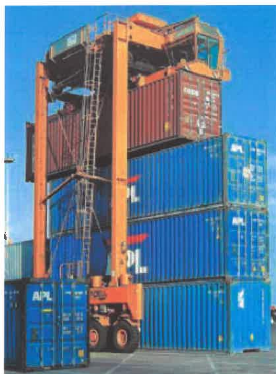
Σχήμα 3.4.3: Στοιβάσια 4 εμπορευματοκιβωτίων. Πηγή: (21)
