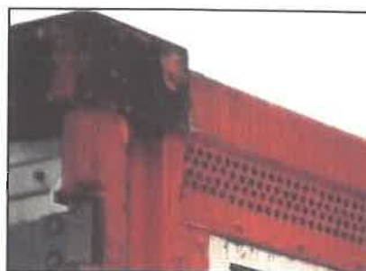
Σχήμα 2.1.14: Εμπορευματοκιβώτιο γενικού σκοπού με μη-μηχανικό εξαερισμό Πηγή: (1)
