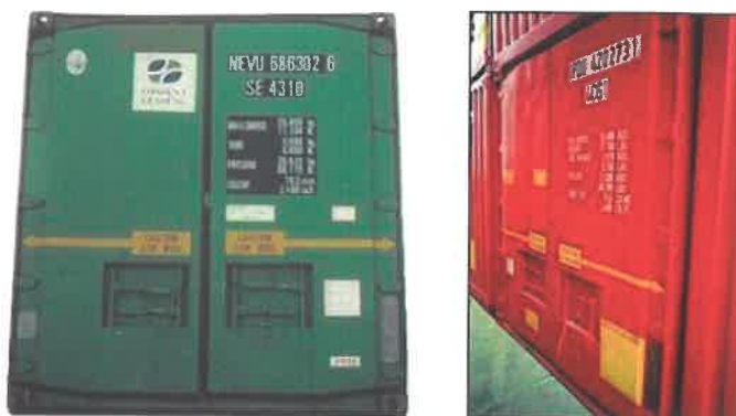
Σχήμα 2.1.8: Εμπορευματοκιβώτια 40' συμβατά με παλέτες. Πηγή: (1)
