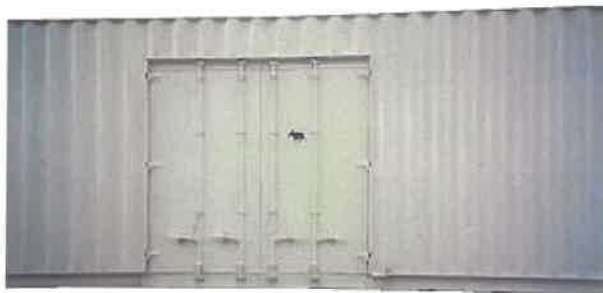
Σχήμα 2.1.12: Εμπορευματοκιβώτιο γενικού σκοπού ειδικά σχεδιασμένο με πλευρικές πόρτες Πηγή: (1)
