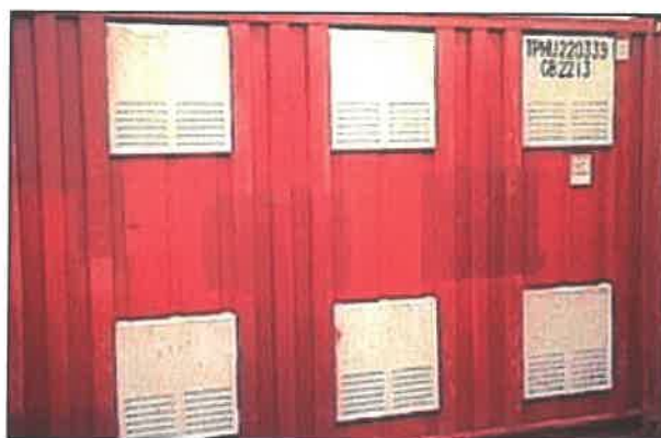
Σχήμα 2.1.15: Εμπορευματοκιβώτιο με μη-μηχανικό εξαερισμό στα ανώτερα και κατώτερα τμήματά του Πηγή: (1)
