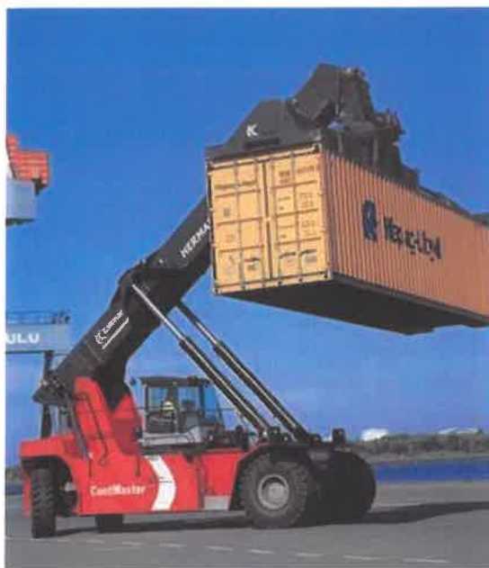
Σχήμα 3.4.5: Οχήματα εμπρόσθιας στοιβασίας (reach-stackers) Πηγή: (23)
