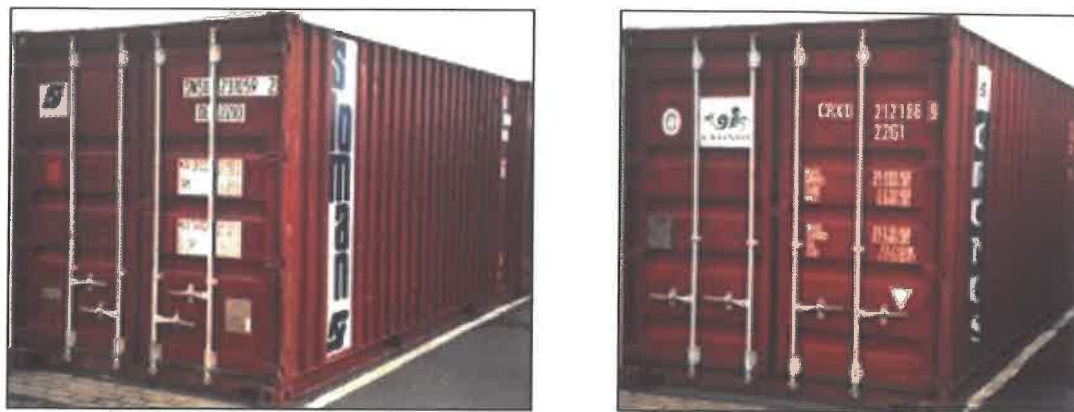
Σχήμα 2.1.1.: Μη εξαεριζόμενα εμπορευματοκιβώτια γενικού σκοπού Πηγή: (1)
