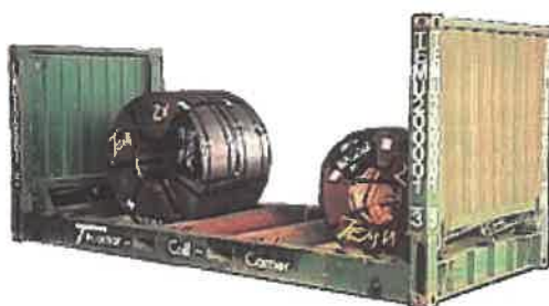
Σχήμα 2.1.35: Εμπορευματοκιβώτιο μεταφοράς ρολών Πηγή: (1)
