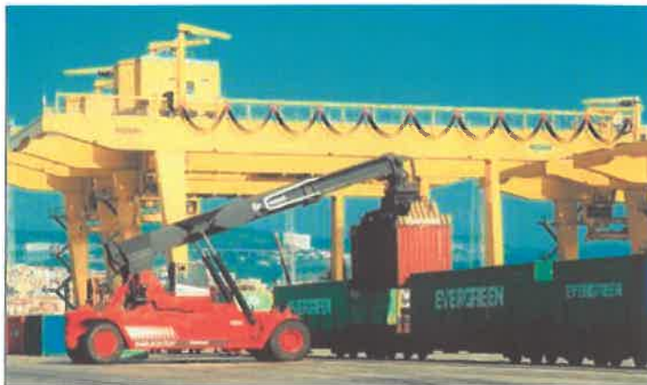
Σχήμα 3.3.12: Πλαισιωτή γερανογέφυρα επί σιδηροτροχιών Πηγή: (16)
