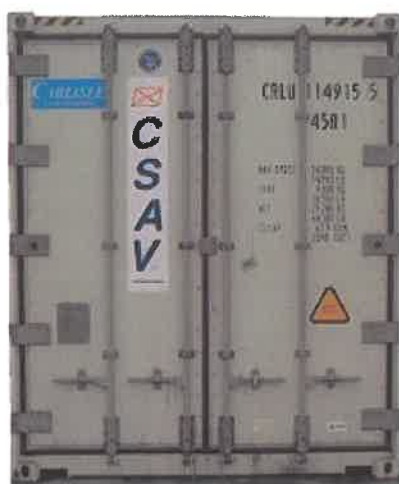
Σχήμα 2.1.23: Θερμικό εμπορευματοκιβώτιο με ενσωματωμένη μονάδα ψύξης Πηγή: (1)
