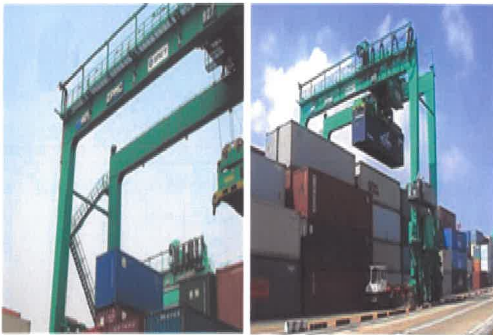
Σχήμα 3.3.5: Γερανογέφυρα συμβατική (αριστερά) και «πράσινη» (δεξιά) Πηγή: (17)
