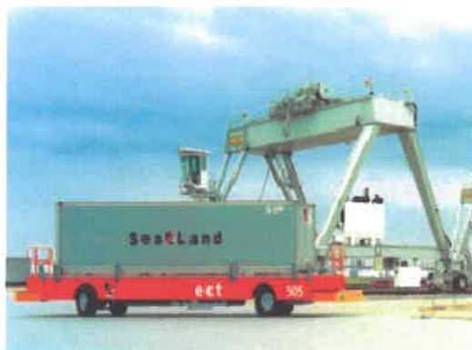
Σχήμα 3.2.4: Αυτόματο Όχημα Μεταφοράς τύπου AGV Πηγή: (9)
