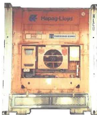
Σχήμα 2.1.27: Ολοκληρωμένο σύστημα ψύξης/θέρμανσης για σύνδεση προς παροχή ενέργειας στη ξηρά ή στο πλοίο
