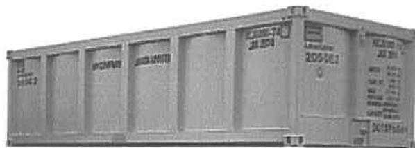
Σχήμα 2.1.37: Εμπορευματοκιβώτιο-βυτίο μεταφοράς μισού ύψους Πηγή: (1)
