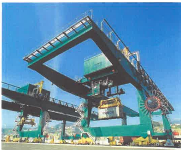
Σχήμα 3.3.12: Πλαισιωτή γερανογέφυρα επί σιδηροτροχιών Πηγή: (16)
