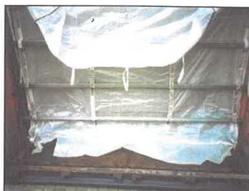
Σχήμα 2.1.22: Εσωτερικές επενδύσεις σε εμπορευματοκιβώτιο γενικού σκοπού για μεταφορά χύδην φορτίου
