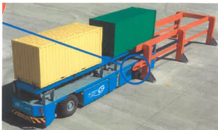
Σχήμα 3.2.8.: Λειτουργία οχημάτων lift-AGV
