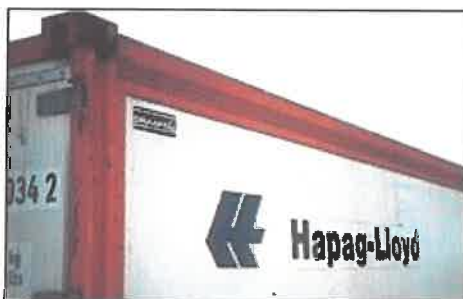
Σχήμα 2.1.14: Εμπορευματοκιβώτιο γενικού σκοπού με μη-μηχανικό εξαερισμό Πηγή: (1)
