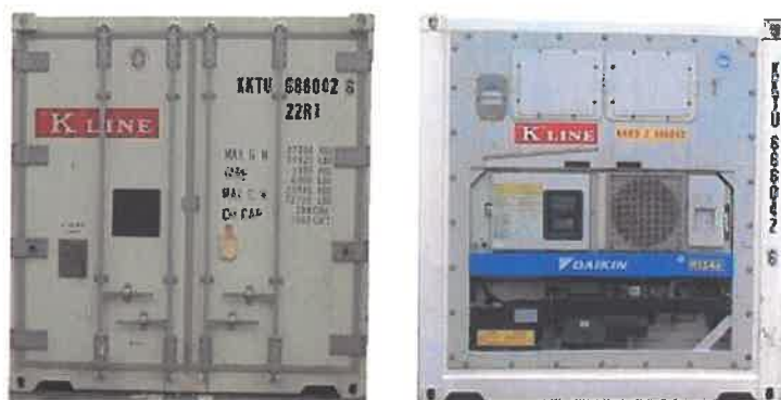
Σχήμα 2.1.25: Θερμικό εμπορευματοκιβώτιο 20'x8'6" ψυχόμενο/θερμαινόμενο μηχανικά
