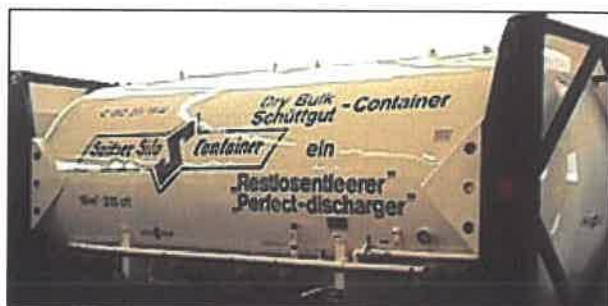
Σχήμα 2.1.20: Εμπορευματοκιβώτιο χύδην φορτίου με εξοπλισμό εκκένωσης με πεπιεσμένο αέρα
