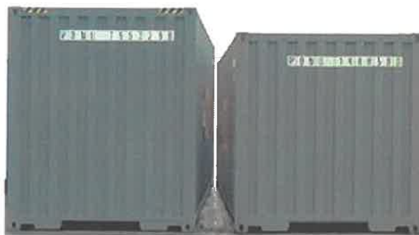
Σχήμα 2.1.6: Σύγκριση μεγάλου ύψους εμπορευματοκιβωτίου (9'6") με εμπορευματοκιβώτιο των 8'6".
