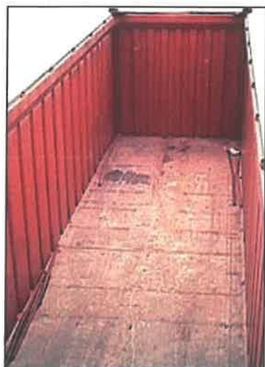
Σχήμα 2.1.31: Εμπορευματοκιβώτιο ανοικτής οροφής χωρίς κάλυψη οροφής
