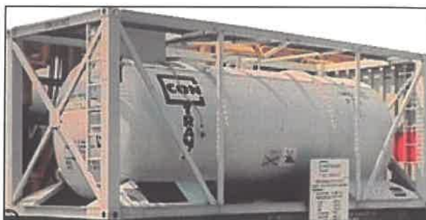
Σχήμα 2.1.21: Εμπορευματοκιβώτιο χύδην φορτίου Πηγή: (1)
