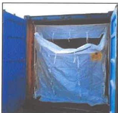
Σχήμα 2.1.22: Εσωτερικές επενδύσεις σε εμπορευματοκιβώτιο γενικού σκοπού για μεταφορά χύδην φορτίου
