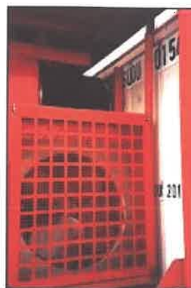
Σχήμα 2.1.29: Θερμικό μονωμένο εμπορευματοκιβώτιο με εξωτερική μονάδα παροχής ενέργειας
