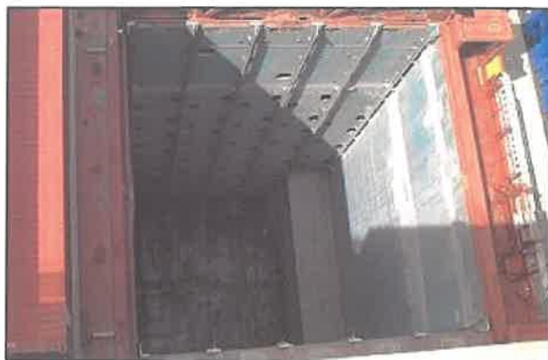
Σχήμα 2.2.15: Ασφάλιση εμπορευματοκιβωτίων με κυψέλες οδηγούς Πηγή: (1)
