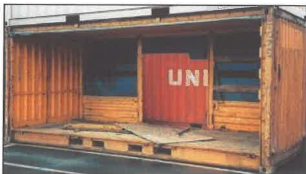
Σχήμα 2.1.7: Εμπορευματοκιβώτιο χωρίς πλευρικά τοιχώματα. Πηγή: (1)
