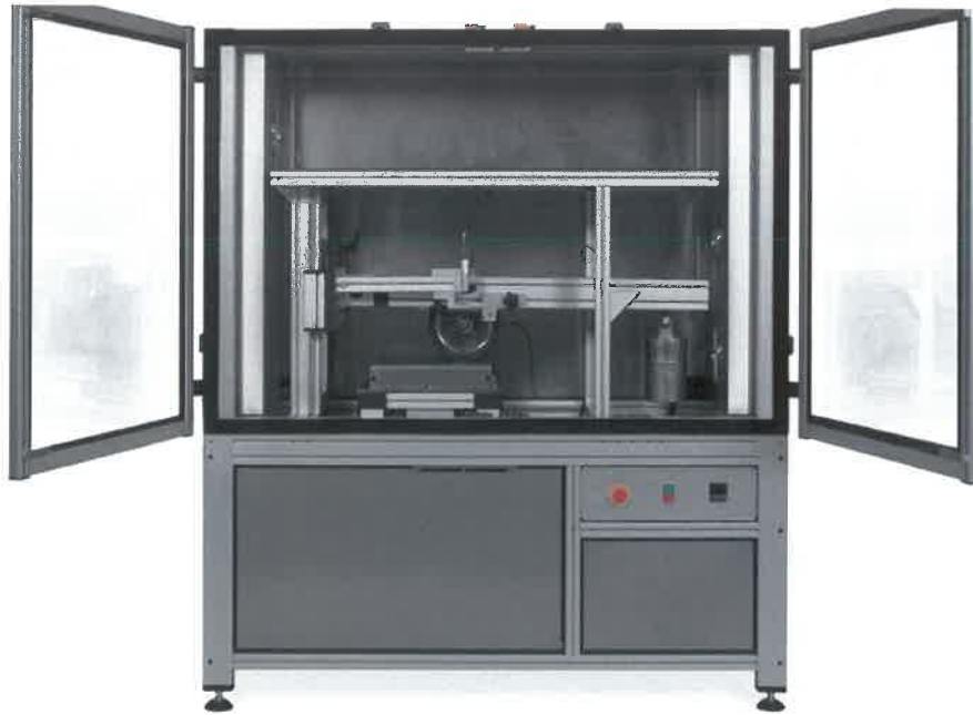
Σχήμα 4.18 : Μικρής κλίμακας συσκευή ελέγχου τροχοαυλάκωσης
