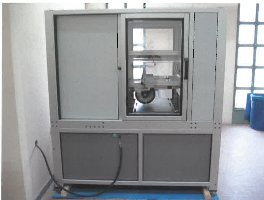
Σχήμα 6.1 : Συσκευή ελέγχου τροχοαυλάκωσης (Wheel tracker device)
