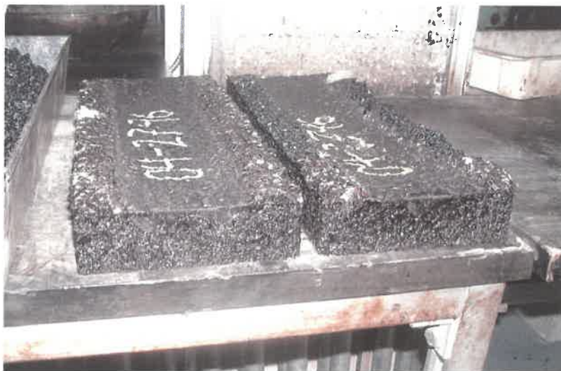
Σχήμα 4.8 : Βάθος τροχοαυλάκωσης σε δοκίμια μετά το πέρας της δοκιμής
