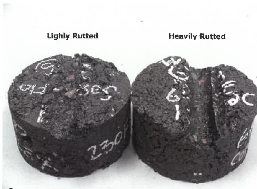
Σχήμα 4.15 : Δείγμα ανθεκτικό (αριστερά ) και μη ανθεκτικό (δεξιά) στην τροχοαυλάκωση
