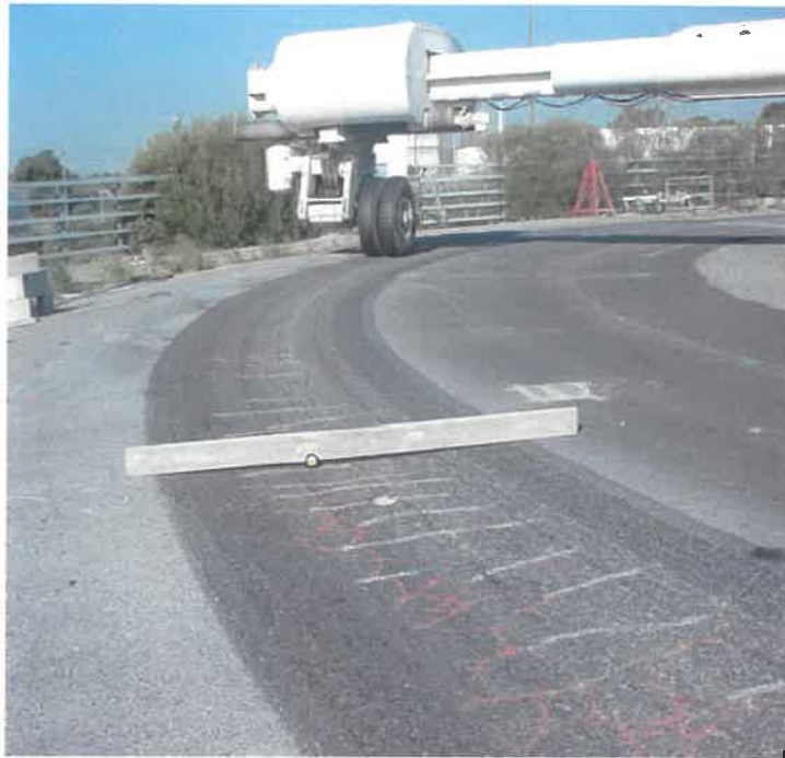
Σχήμα 4.27 : Μετρήσεις βάθους τροχοαυλάκωσης σε πειραματικό οδόστρωμα
