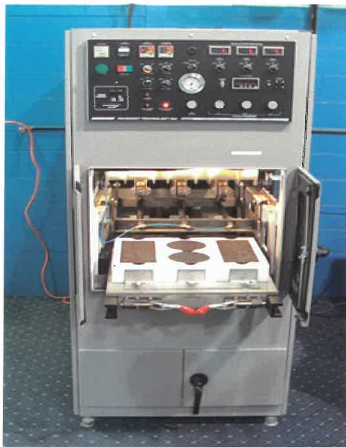
Σχήμα 4.11 : Συσκευή τροχοαυλάκωσης APA
