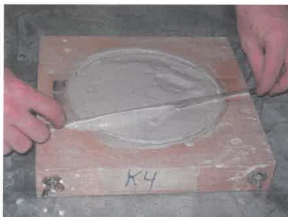
Σχήμα 5.19 : Απομάκρυνση πλεονάσματος ασβεστοκονιάματος
