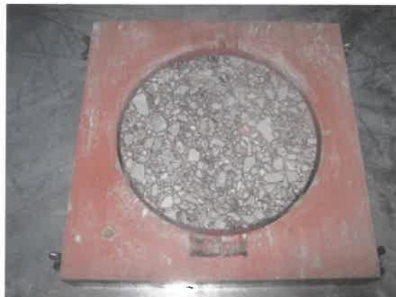
Σχήμα 5.17 : Τοποθέτηση πυρήνα εντός της μήτρας
