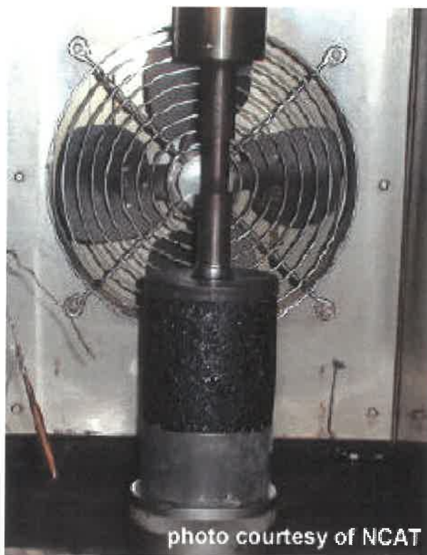
Σχήμα 3.2 : Συσκευή εκτέλεσης μονοαξονικής δοκιμής ερπυσμού
