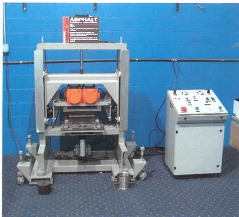
Σχήμα 4.12 : Συσκευής συμπίκνωσης δειγμάτων (Vibratory Compactor)
