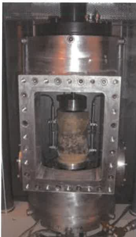
Σχήμα 3.3 : Συσκευή εκτέλεσης δοκιμών υπό τριαξονική φόρτιση
