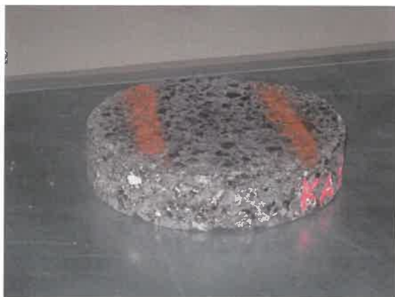
Σχήμα 5.6 : Πυρήνας με προσημασμένη την κατεύθυνση κυκλοφοριακής ροής
