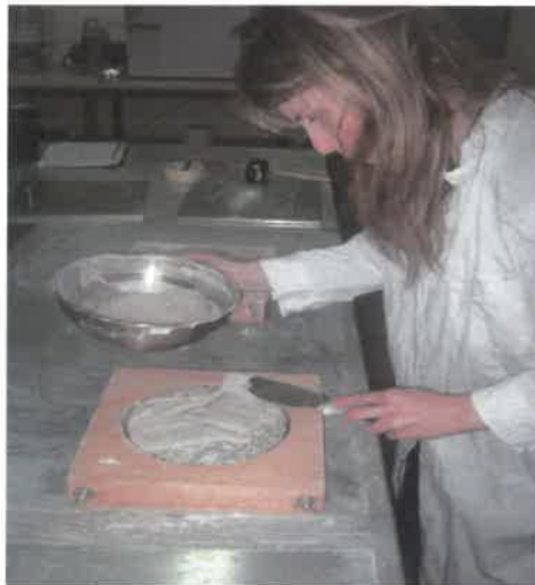
Σχήμα 5.18 : Πλήρωση κενών μεταξύ μήτρας και πυρήνα
