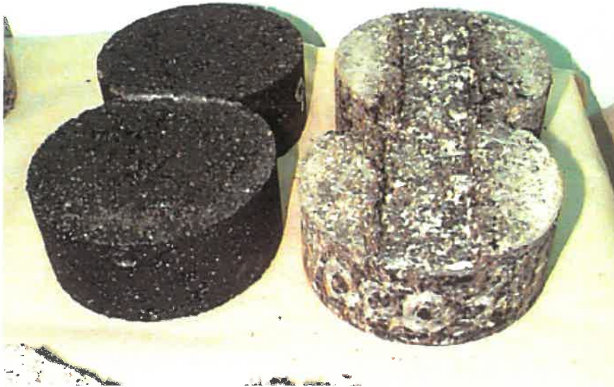
Σχήμα 4.4 : Δείγματα πριν και μετά την δοκιμή τροχοαυλάκωσης
