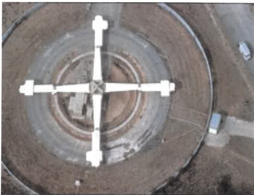
Σχήμα 4.22 : Δοκιμή τροχοαυλάκωσης σε πειραματικό οδόστρωμα (full scale testing)
