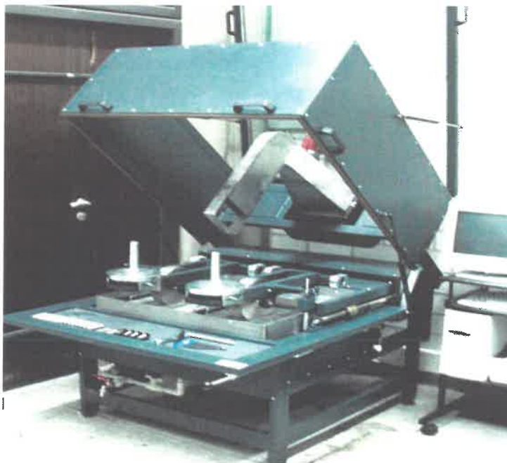
Σχήμα 4.1 : Συσκευή ελέγχου τροχοαυλάκωσης HWRT
