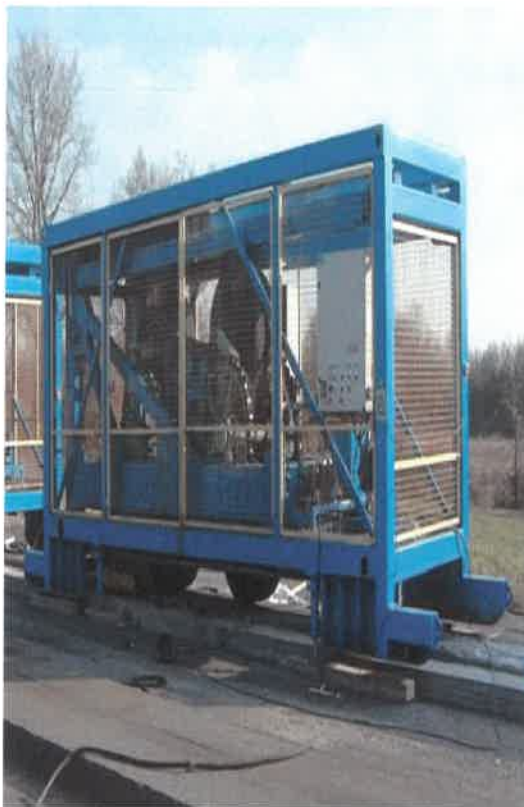
Σχήμα 4.23 : Συσκευή προσομοίωσης φόρτισης οδοστρώματος (LCPC)
