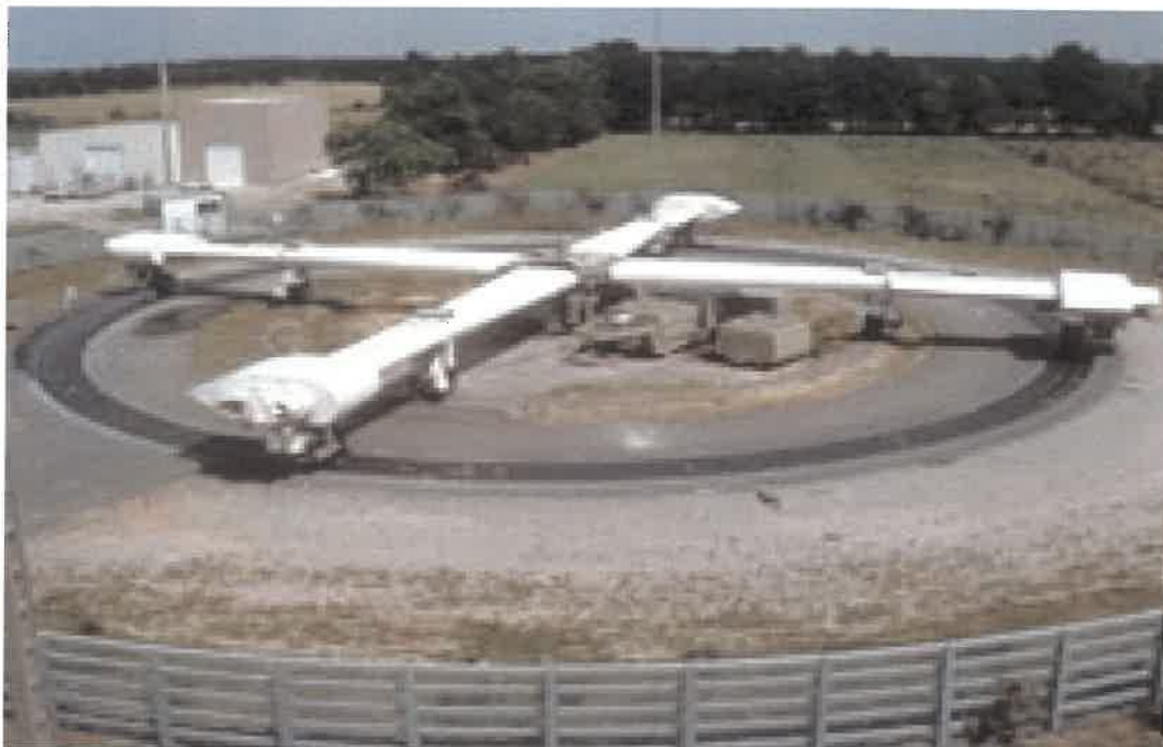
Σχήμα 4.24 : Εγκατάσταση που προσομοιώνει τις συνθήκες κυκλοφορίας (carousel)
