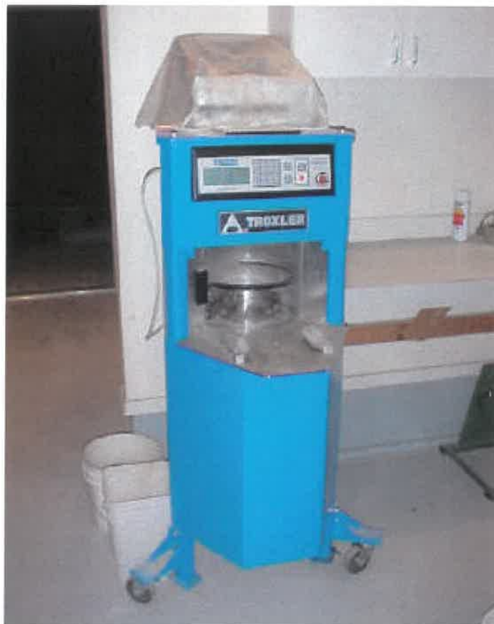
Σχήμα 4.10 : Συμπύκνωση κυλινδρικών δοκιμίων με τη γυροσκοπική μέθοδο (Gyratory Compactor)
