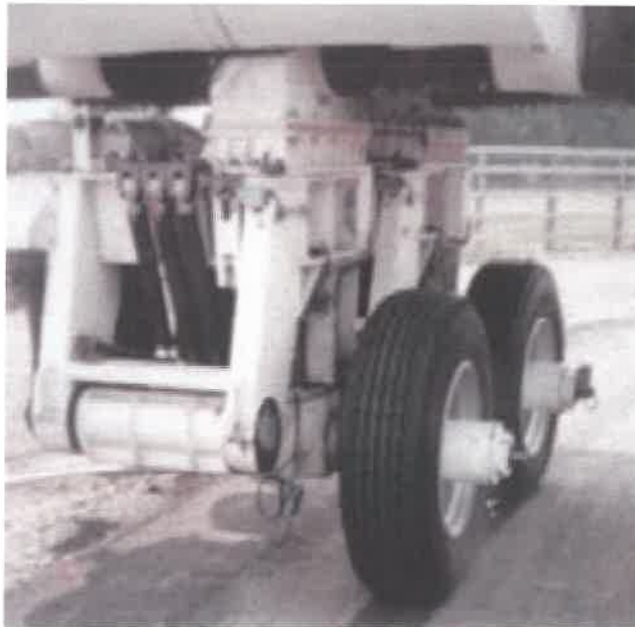
Σχήμα 4.25 : Κυλιόμενοι μονοί τροχοί ενσωματωμένοι στους βραχίονες του
