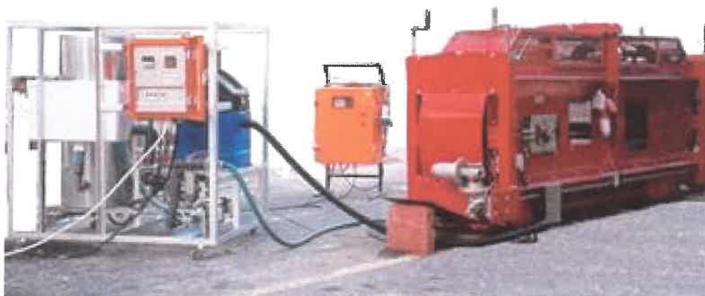
Σχήμα 4.31 : Συσκευής ελέγχου τροχοαυλάκωσης MMLS3
