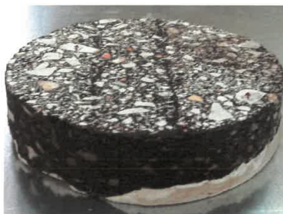
Σχήμα 6.14 : Βάθος τροχοαυλάκωσης σε πυρήνα ισοπεδωτικής στρώσης
