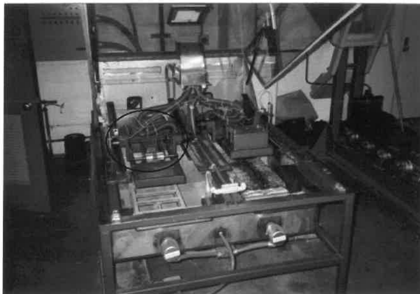
Σχήμα 4.16 : Συσκευή τροχοαυλάκωσης PURW
