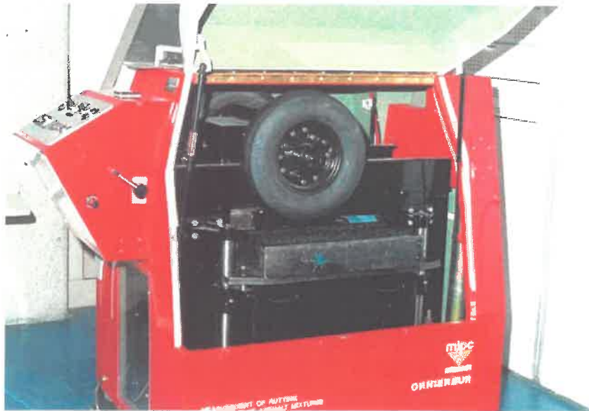
Σχήμα 4.5 : Συσκευή ελέγχου τροχοαυλάκωσης FLRT
