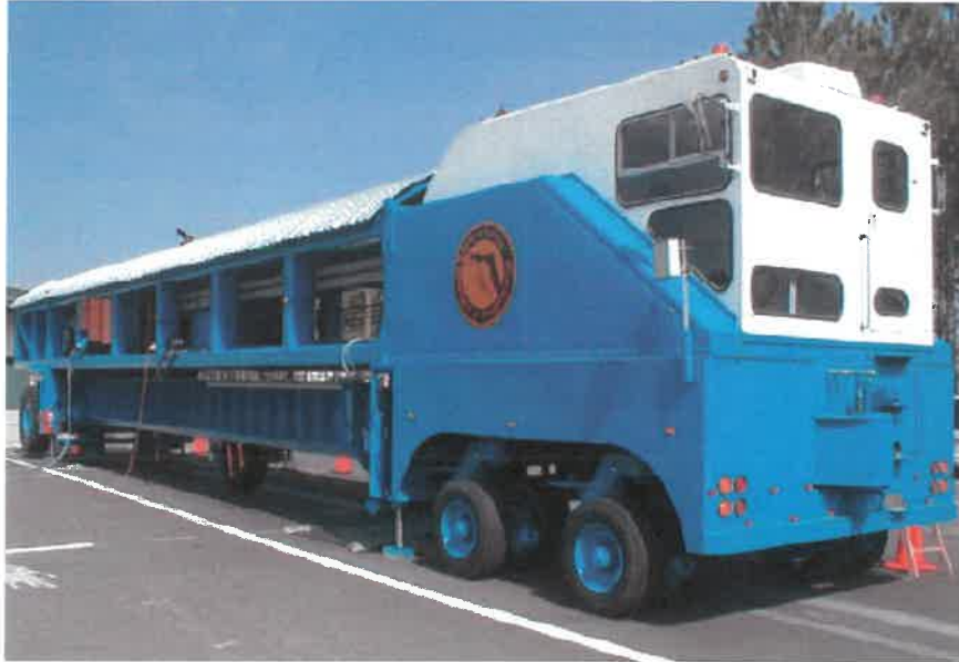
Σχήμα 4.33 : Συσσκευή ελέγχου τροχοαυλάκωσης HVS
