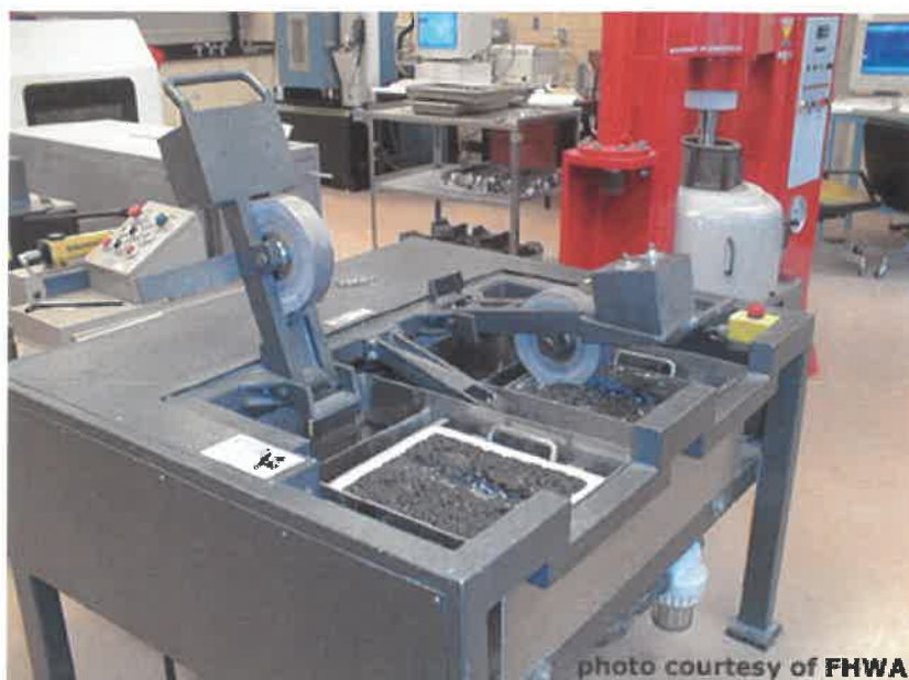
Σχήμα 4.3 : Έλεγχος δοκιμίων σε ξηρές συνθήκες
