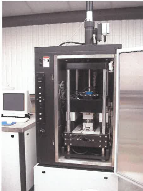
Σχήμα 3.6 : Συσκευή διάτμησης (Superpave Shear Tester)
