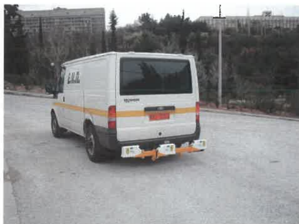
Σχήμα 2.5 : Μέτρηση βάθους τροχοαυλάκωσης με την χρήση προφιλόμετρου
