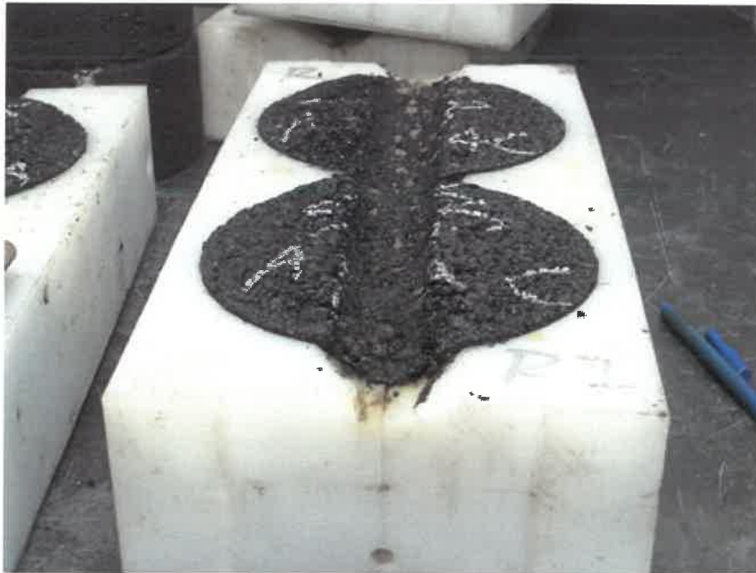
Σχήμα 4.14 : Βάθος τροχοαυλάκωσης σε δείγματα μετά από 8000 κύκλους φόρτισης
