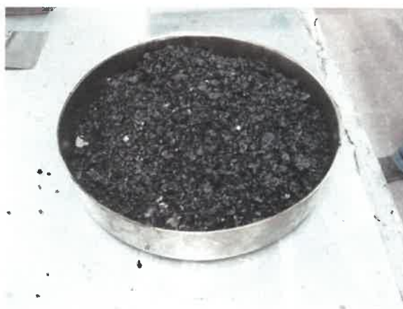
Σχήμα 5.5 : Επιλεγμένο δείγμα από μονάδα παραγωγής ασφαλτομίγματος
