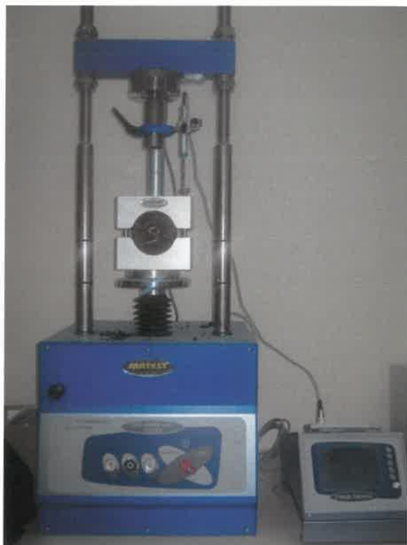
Σχήμα 3.4 : Συσκευή ελέγχου δοκιμών σε ευστάθεια και παραμόρφωση (συσκευή Marshall)
