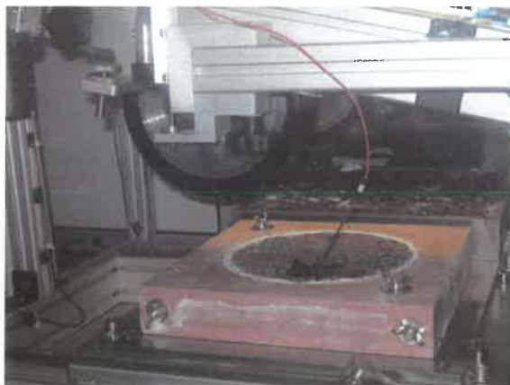
Σχήμα 5.22 : Προθέρμανση πυρήνα στη συσκευή τροχοαυλάκωσης
