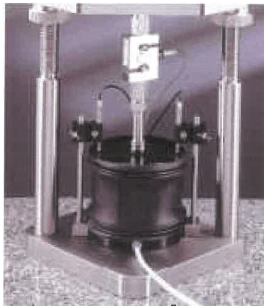
Σχήμα 5.3 : Διάταξη για την εκτέλεση της δοκιμής ερπυσμού υπό δυναμικό φορτίο
