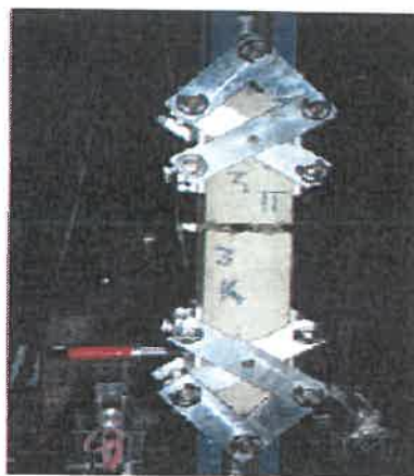
Εικόνα 2.4 Δοκιμή σε εφελκυσμό με συσκευή MTS
