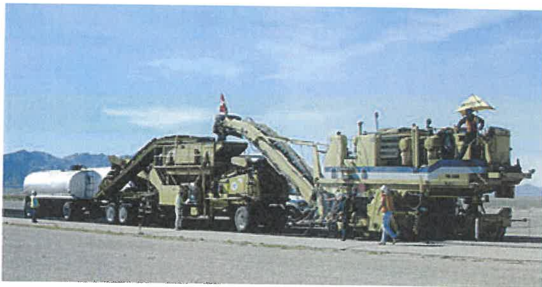
Εικόνα 1.6 τυπικός ανακυκλωτής-συρμός επί τόπου ψυχρής ανακύκλωσης [22]
