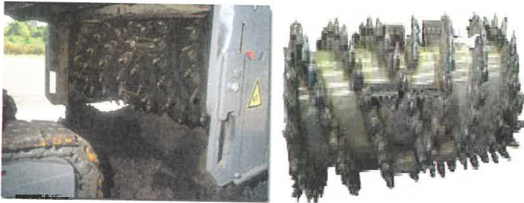
Εικόνα 1.5 Τύμπανο φρεζαρίσματος και θρυμματισμού [23]
