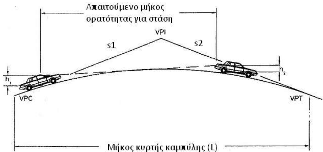
Σχήμα 2.12 : Απαιτούμενο μήκος ορατότητας για στάση σε κυρτή καμπύλη [1]
