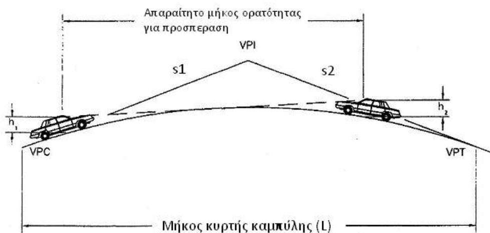
Σχήμα 2.14 : Απαιτούμενο μήκος ορατότητας για προσπέραση σε κυρτή καμπύλη [1]
