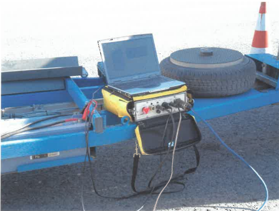
Σχήμα 5.4 Σύνδεση της μονάδας ελέγχου με τον υπολογιστή
