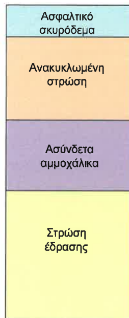
Σχήμα 4.1 Στατικό πρότυπο του υπό εξέταση οδοστρώματος
