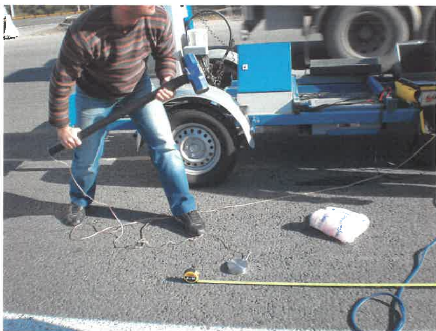
Σχήμα 5.7 Διαδικασία παραγωγής επιφανειακών κυμάτων
