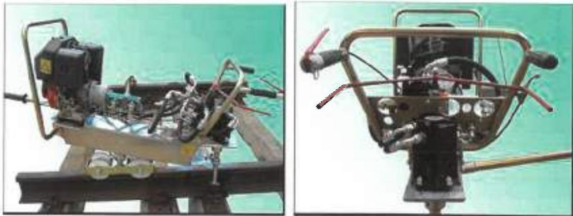
Εικόνα 4.14 και 4.15. Χειροκίνητη συσκευή κοχλίωσης
