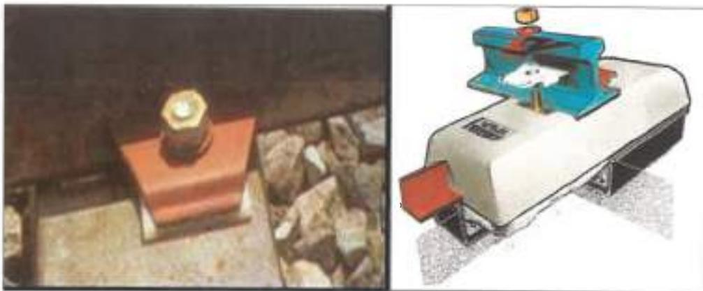
Εικόνα 4.6 και 4.7. Σύνδεση NABLA επί διμερών στρωτήρων
