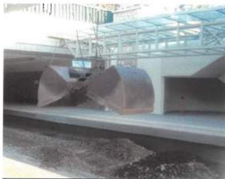
**Εικόνα 13.3.** Ειδική σέσουλα εκφόρτωσης σκύρων κατ εδαφικών υλικών
