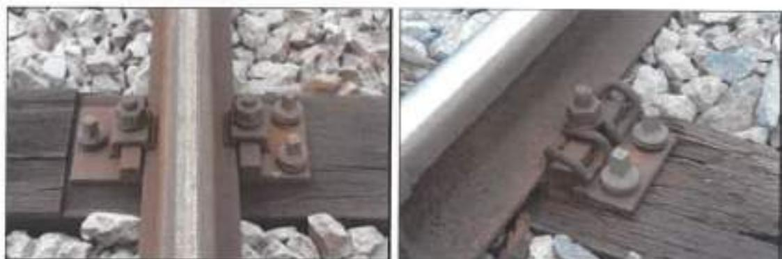
Εικόνα 4.2 και 4.3. Σύνδεση μορφής K (αριστερά) και μορφής KS (δεξιά) επί ξύλινων στρωτήρων
