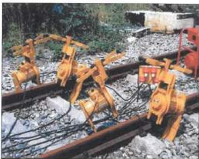
Εικόνα 13.8. Ηλεκτροκίνητο μηχανήματα για υπογόμωση διο χειρός
