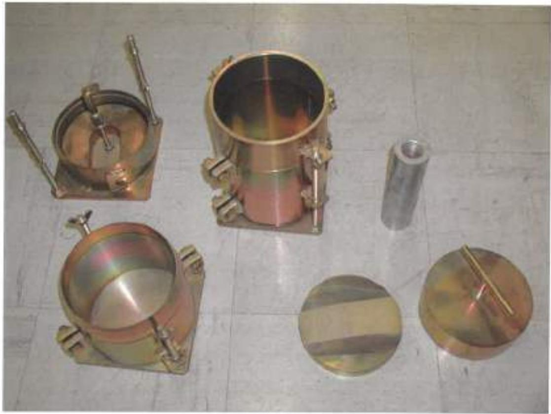
Σχήμα 4.4. Εξοπλήματα συσκευής CBR
