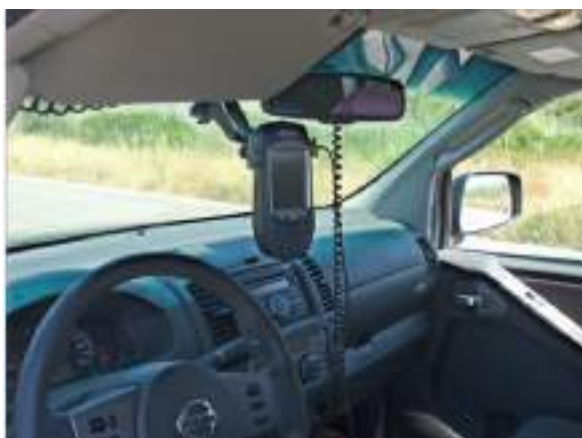
Σχήμα 4. 6 Ο δέκτης GPS τοποθετημένος στο μπροστινό μέρος του οχήματος.
