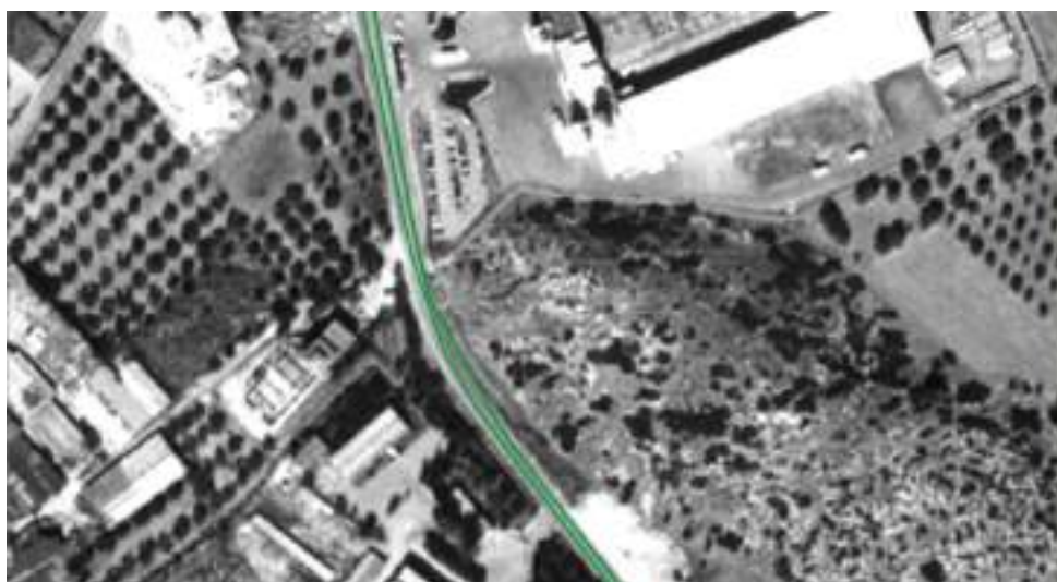
Σχήμα 4. 11 Τμήμα της καταγραφείσας διαδρομής σε μία στροφή όπως αυτή απεικονίζεται στον ορθοφωτοχάρτη.
