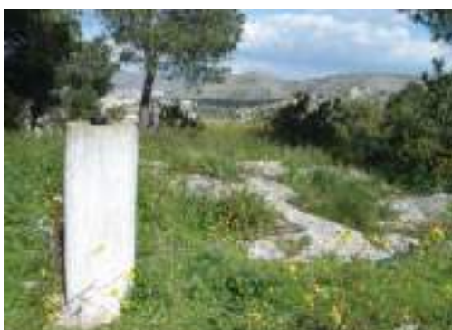
Σχήμα 4. 3 Φωτογραφία από το τριγωνομετρικό σημείο 37969 Μπαταριά της Γ.Υ.Σ. με βάθρο ύψους 1.11 μέτρα.
