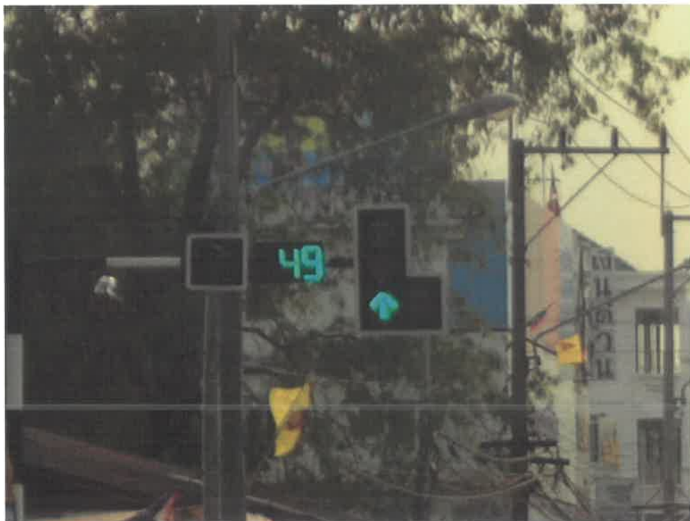
Αντίστροφη μέτρηση για την κόκκινη σήμανση (πόσα δευτερόλεπτα πράσινης ένδειξης απομένουν). Το ίδιο γίνεται (με κόκκινο χρώμα) όταν επίκειται πράσινη ένδειξη (Sakon Nakhon, Ταϊλάνδη)
