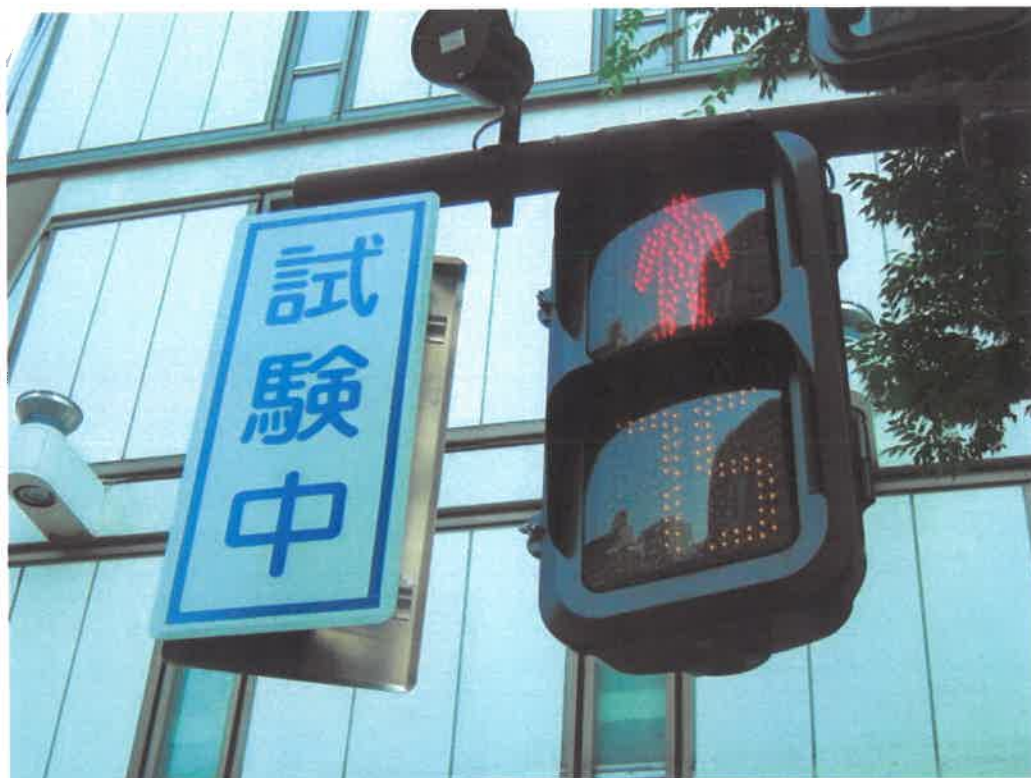
Αντίστροφη μέτρηση της κόκκινης ένδειξης για τους πεζούς (Nagoya, Ιαπωνία)
