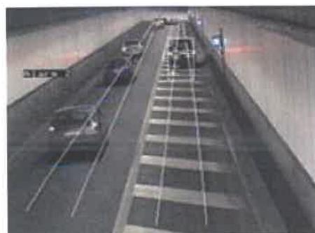
Σχ.1.75 και Σχ.1.76: Αυτόματη ανίχνευση διαφόρων ειδών περιστατικών (τροχαίου ατυχήματος αριστερά και σταματημένου οχήματος σε σήραγγα δεξιά) (ΠΗΓΗ: [12])
