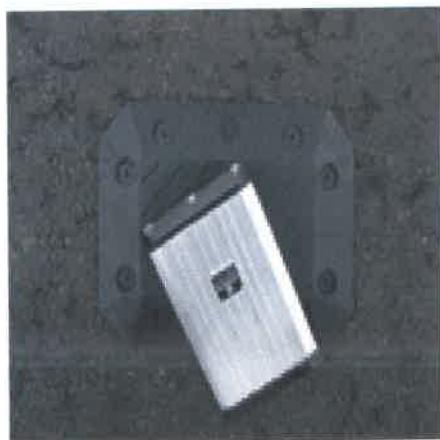
**Σχ.1.44:** Φορητός μετρητής κυκλοφοριακών φόρτων ο οποίος εγκαθίσταται πάνω στην επιφάνεια του οδοστρώματος (ΠΗΓΗ: [www.quixotecorp.com](http://www.quixotecorp.com))
