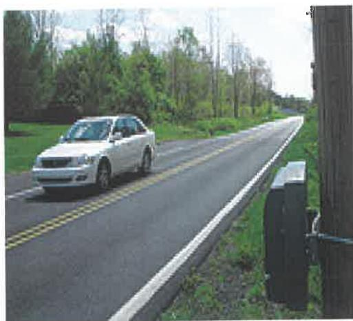
**Σχ.1.77:** Μέτρηση κυκλοφοριακών φόρτων, στην πράξη, με τη χρήση ακουστικού ανιχνευτή.
