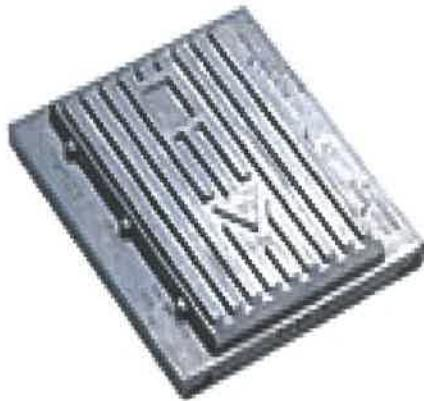
**Σχ.1.43:** Φορητός κυκλοφοριακών φόρτων ο οποίος εγκαθίσταται πάνω στην επιφάνεια του οδοστρώματος (ΠΗΓΗ: [www.quixotecorp.com](http://www.quixotecorp.com))
