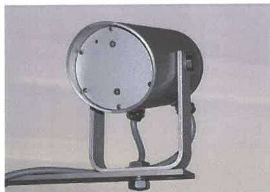
**Σχ.2.5.11:** Ανιχνευτής κυκλοφορίας με μικροκύματα (ΠΗΓΗ: [www.asim-technologies.com](http://www.asim-technologies.com))
