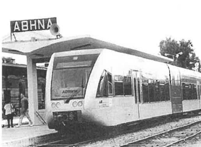
β. Η τετραξονική επιβατική αυτοκινητάμαξα (ισχύς κινητήρα μέχρι 750 HP), η οποία μπορεί να λειτουργεί είτε ως ανεξάρτητη, είτε ως έλκουσα όχημα χωρίς κινητήρα, ή να συντεθεί ημιμόνιμα σε πολλαπλή μονάδα (multiple-unit), που αξιοποιεί το σύνολο ή μέρος της συνολικής ισχύος των διαθέσιμων κινητήρων.
