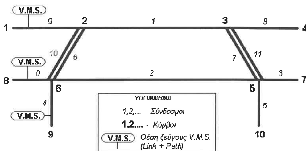
Σχήμα 6.13: Θέση ζευγών V.M.S. περίπτωσης B
