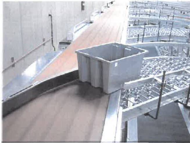
Εικόνα 3.6.3 Μηχανικός βραχίονας εκτροπής αποσκευών [Πηγή: 13]
