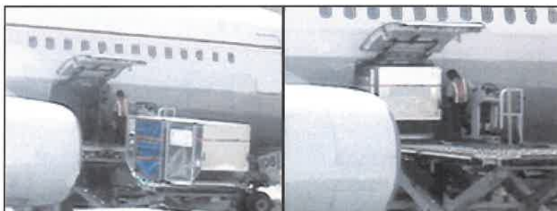
Εικόνα 3.1.6 Φόρτωση αεροσκάφους με Ε/Κ [Πηγή: 11]
