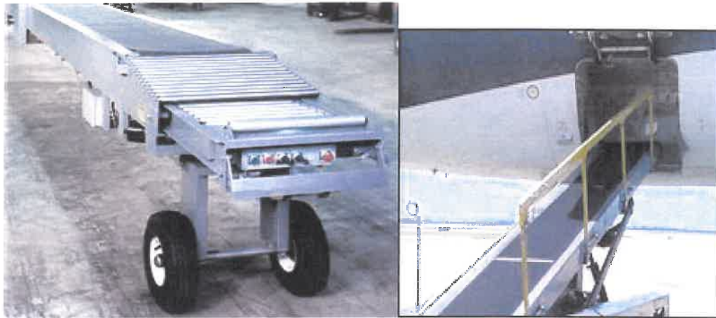
Εικόνα 3.6.7 Κινητή μεταφορική ταινία με ιμάντα [Πηγή: 9&11]
