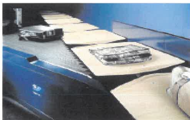
Εικόνα 3.4.4 Σύστημα μεταφοράς αποσκευών με ανατρεπόμενους δίσκους [Πηγή: 9]
