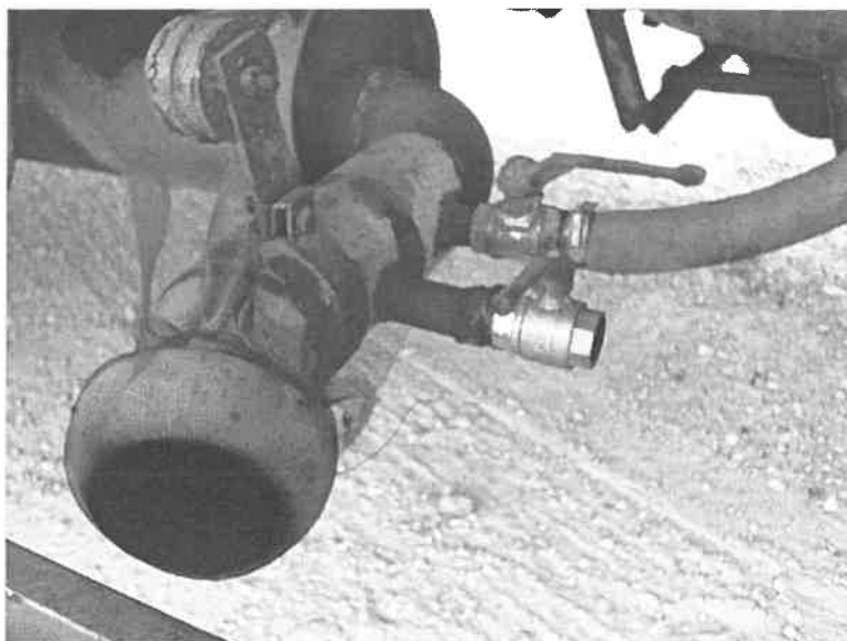
Σχήμα 2.12 Τυπική διάταξη σωληνώσεων εκτροπής καυσαερίων
