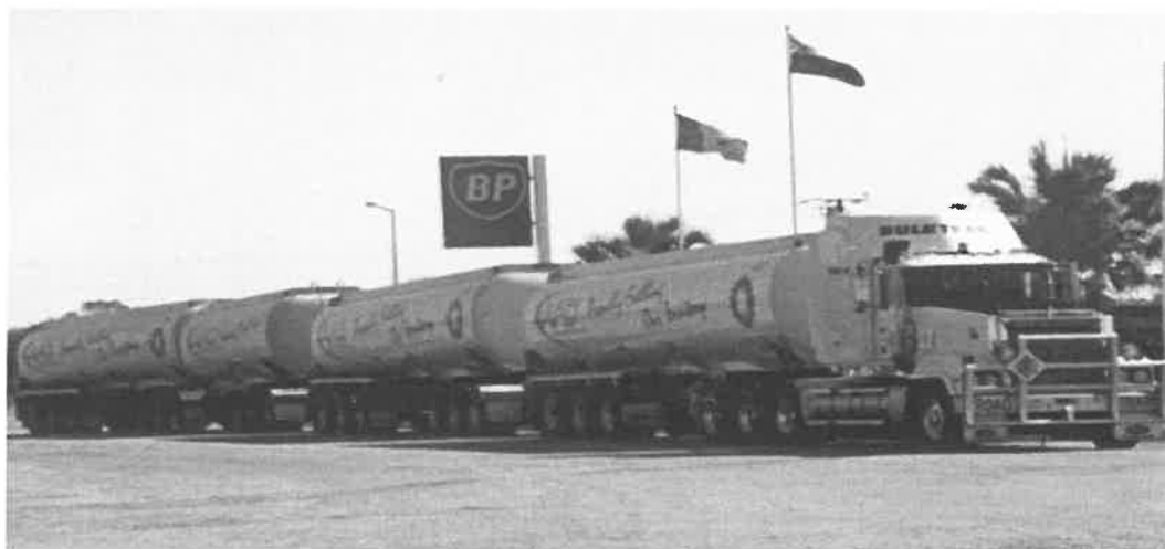
Σχήμα 2.4 Οδικός συρμός μεταφοράς καυσίμων 5 οχημάτων στην Αυστραλία
