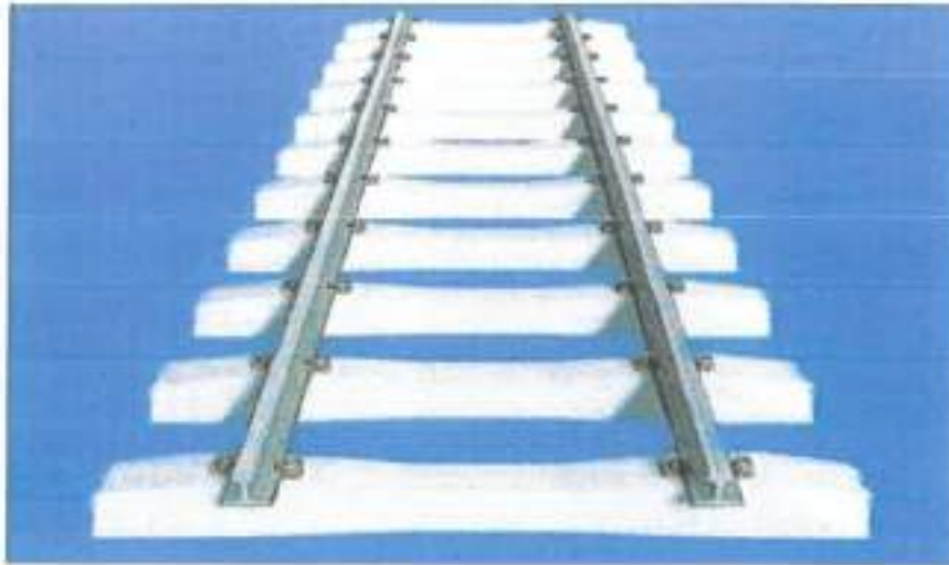
Εικόνα 5.1: Τυπική διάταξη γραμμής με μπετονένιους στρωτήρες και σιδηροτροχιά με διατομή Vignol (πηγή: δικτυακός τόπος www.railway-technical.com )
