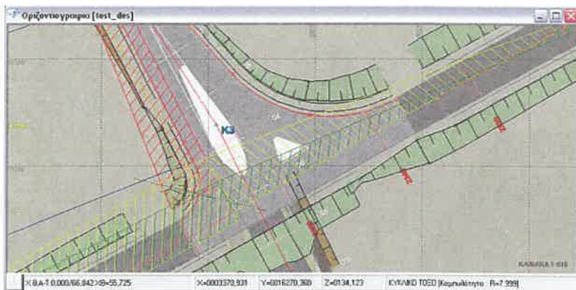
Σχήμα 3.4 : Σχεδιασμός ισόπεδου κόμβου με το πρόγραμμα ΟΔΟΣ 7 [22]
