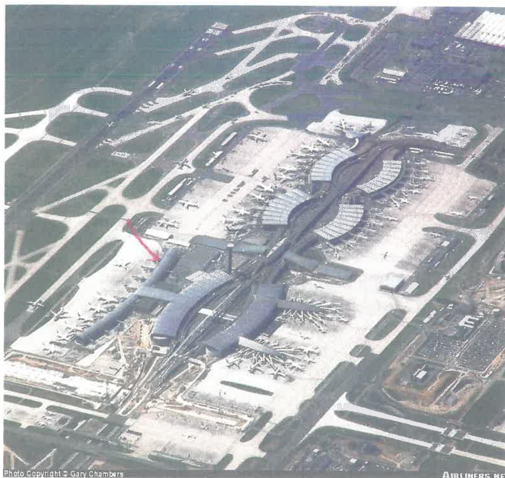
Εικόνα (1.11) Το Charles De Gaulle International Airport αποτελεί ιδανικό συνδυασμό όλων των διατάξεων των αεροσταθμών. Συναντώνται και linear και midfield κτήρια. Το αεροδρόμιο Charles De Gaulle με 4 διαδρόμους προσαπογειώσεων αποτελεί το κομβικό αεροδρόμιο της Air France.
