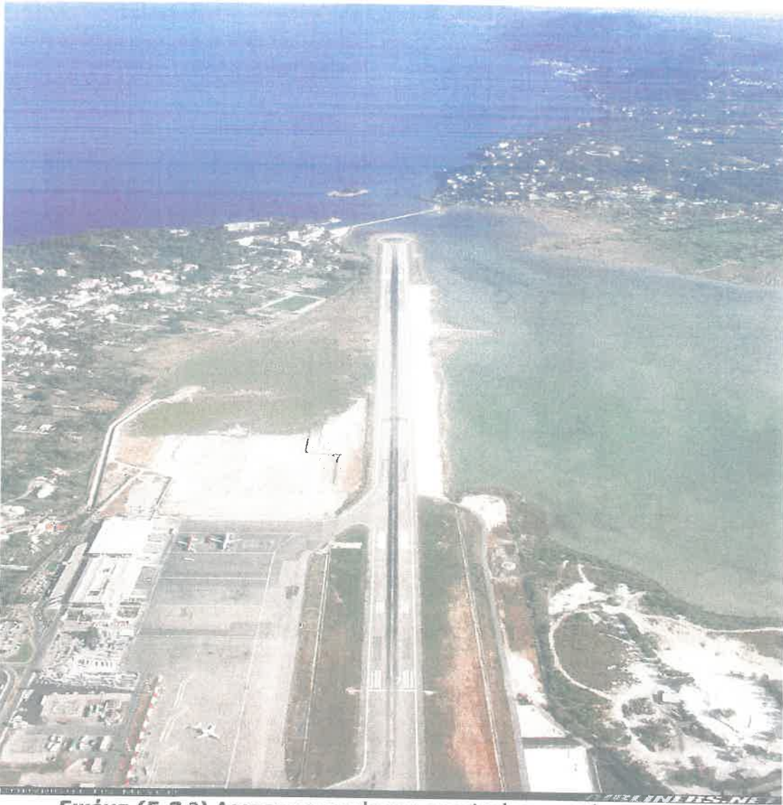
Εικόνα (5.2.2) Αεροφωτογραφία του αερολιμένα της Κέρκυρας όπου διακρίνονται ο διάδρομος προσαπογειώσεων και τα δάπεδα στάθμευσης. (Πηγή: www.airliners.net )
