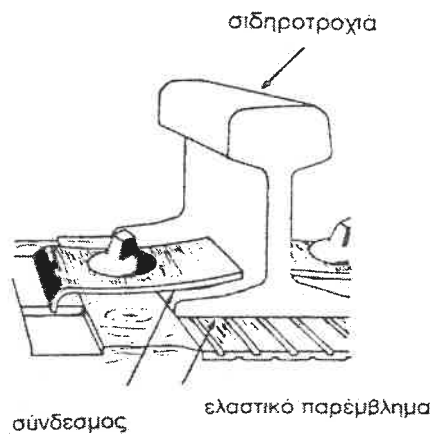
Σχήμα 1.3: Σύνδεση σιδηροτροχιών – στρωτήρων. [16]
