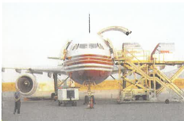
Εικόνα 2.57: Εκφόρτωση κύριου καταστρώματος με όχημα φορτώσεως μοναδοποιημένων φορτίων [Πηγή:28]
