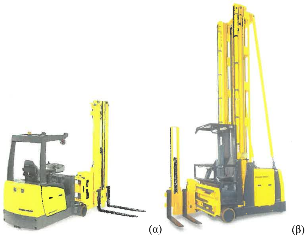
Εικόνα 2.46: Μηχανήματα στενών διαδρόμων, β) με δυνατότητα ανύψωσης του χειριστή [Πηγή:44]
