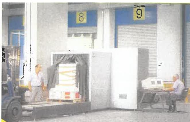
Εικόνα 2.53: Περονοφόρο ανυψωτικό μεταφέρει φορτία στο μηχάνημα έλεγχου με ακτίνες Χ [Πηγή:26]
