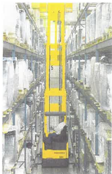
Εικόνα 2.59: Στοιβασία και συλλογή εμπορευμάτων από μηχανήμα στενών διαδρόμων και παλετοφόρο [Πηγή:44]
