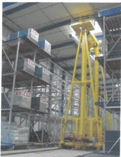
Αποθήκευση άδειων εμπορευματοκιβωτίων σε σύστημα ραφιών στον εμπορευματικό αεροσταθμό του αεροδρομίου Ruzynne της Πράγας.[Πηγή:]
