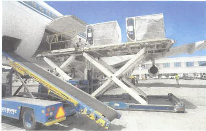
Εικόνα 2.55: Φόρτωση κατώτερου καταστρώματος με όχημα φορτώσεως και μεταφορική ταινία [Πηγή:26]
