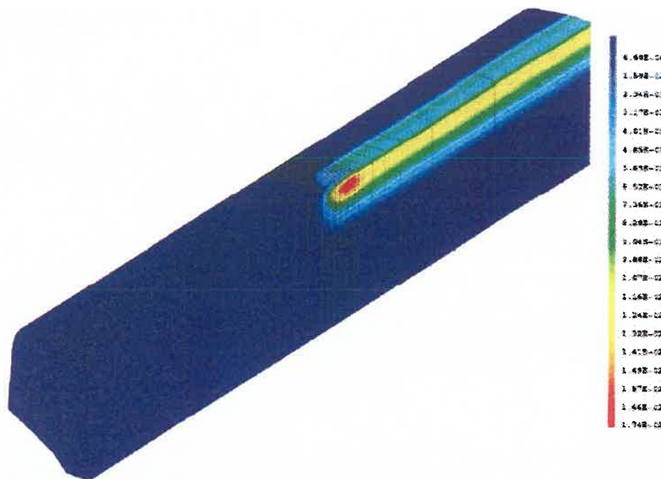
Σχήμα 3.12. Κατανομή τάσεων πλαστικής παραμόρφωσης σε σιδηροτροχιά θεωρώντας σφαιρική κατανομή πίεσης από τον τροχό με ακτίνα επαφής a=10\text{mm} , συντελεστή φόρτισης P_0/k_e = 6.7 και συντελεστή \mu = Q/P=0 . Σιδηροτροχιά τύπου UIC 160. (Πηγή: Ringsberg J.W., Josefson B.L., 2001).
