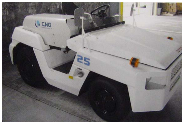
Εικόνα 3.4 : Ελκυστήρας Αεροσκαφών που Λειτουργεί με Φυσικό Αέριο (Πηγή: 2001 New Tokyo International Airport Environmental Report)
