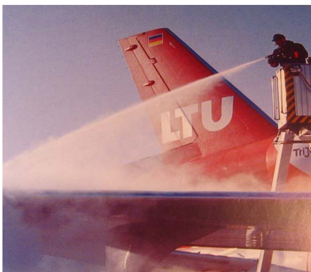
Εικόνα 3.8 : Εφαρμογή Υγρού Αποπαγοποίησης στα Φτερά Αεροσκάφους (Πηγή: 2002 Dusseldorf International Airport Environmental Report)
